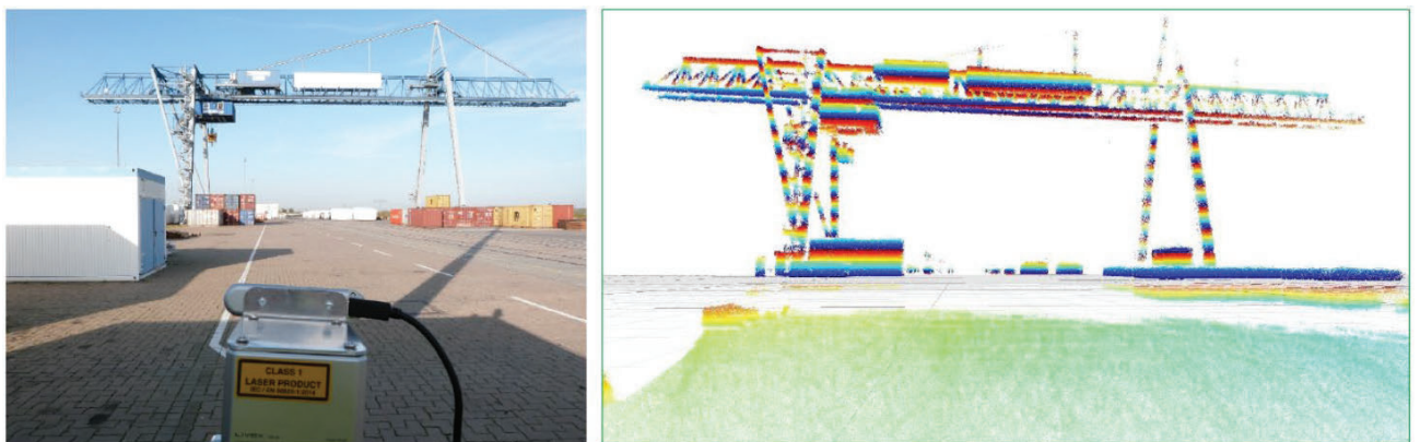
Abbildung 16 Umwelterfassung mit Lidar Mid40 im Hafengebiete (links Farbbild zur Veranschaulichung der Situation, rechts: Punktdaten farblich kodiert nach Höhe über Grundebene)
