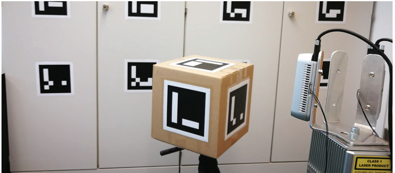
Abbildung 19: Testaufbau für extrinsische Kalibrierung des LiDARs und der Stereo-Kameras
