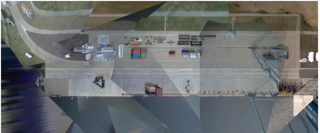
Abbildung 11: Beispielhafte Virtuelle Draufsicht des Testgeländes auf Basis kalibrierter Kameradaten
