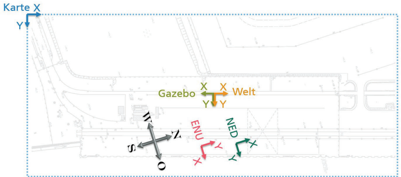
Abbildung 10: Koordinatensysteme im Hafbereich
