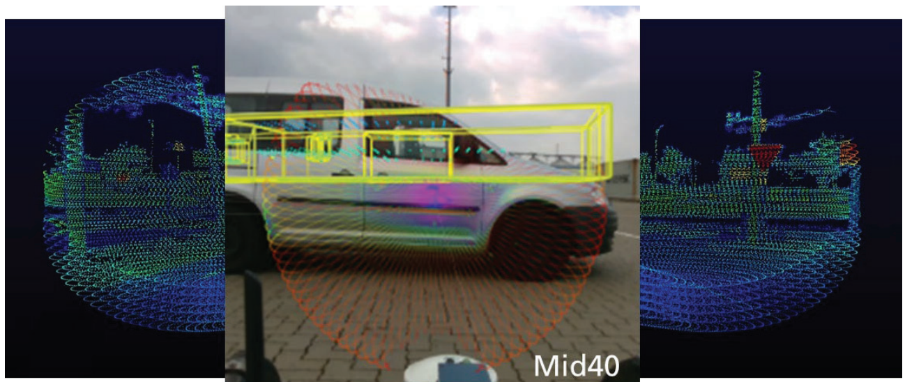
Abbildung 29: Sichtbereich Livox Horizon verglichen mit Aufnahmen des Livox Mid40
