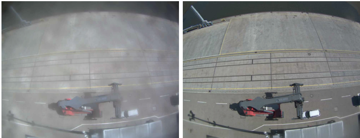
Abbildung 21: Effekt von verschmutzten Kameras (links verschmutzt, rechts gereinigt)
