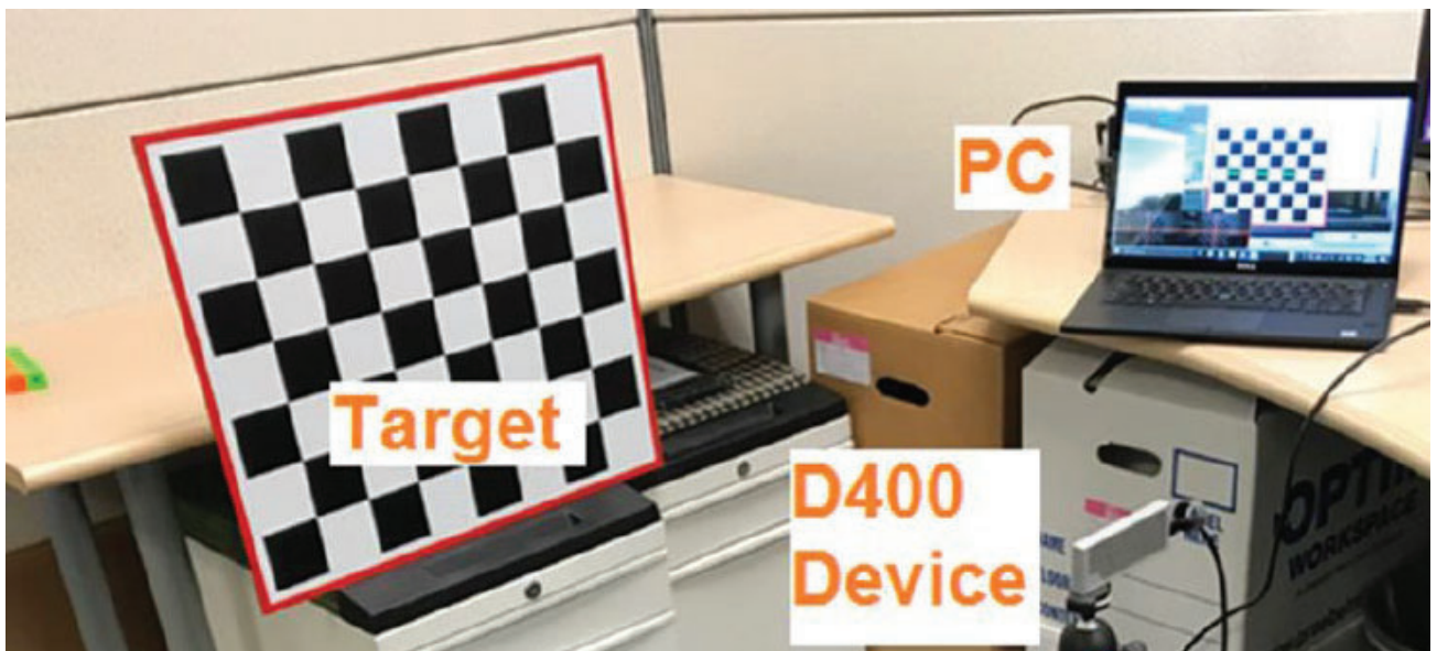
Abbildung 18: Testaufbau für intrinsische Kamerakalibrierung der Stereo-Kameras c
