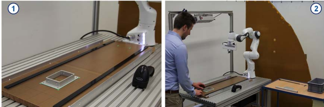
Abbildung 19: Digitale Montagestation; Laserprojektionssystem (1); kollaborative Montage (2)
