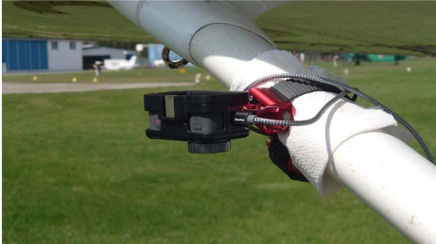
**Abbildung 1-10: Befestigung einer Kamera am Leichtflugzeug**
