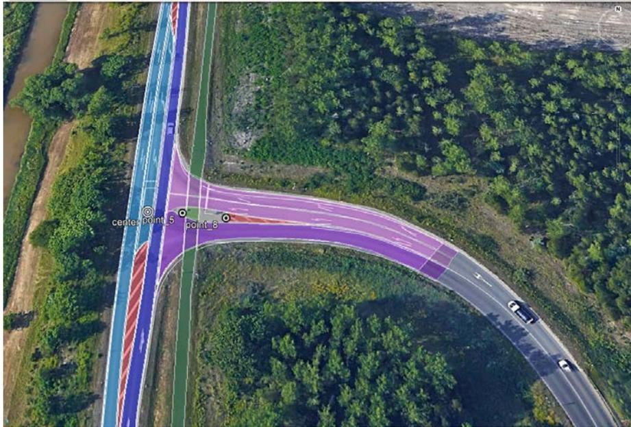
Abbildung 1-3: Beispiel für aus Videodaten extrahierte Fahrrichtungen der Verkehrsteilnehmer (eigene Abbildung Fraunhofer IVI)
