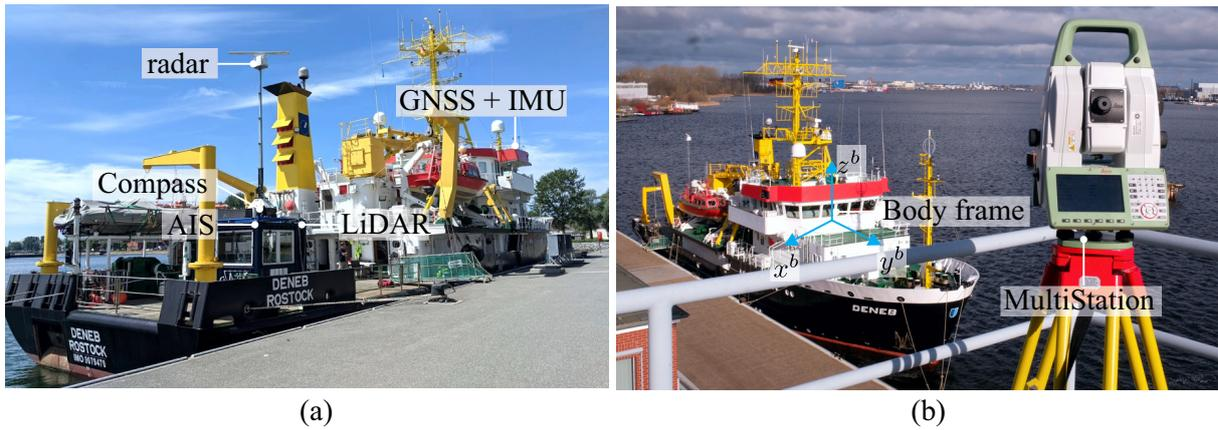
Abbildung 4.21: Sensoreinstellungen am Forschungsschiff DENEb des BSH: (a) und Messung der Sensorenposition mit der Leica MultiStation (b)
