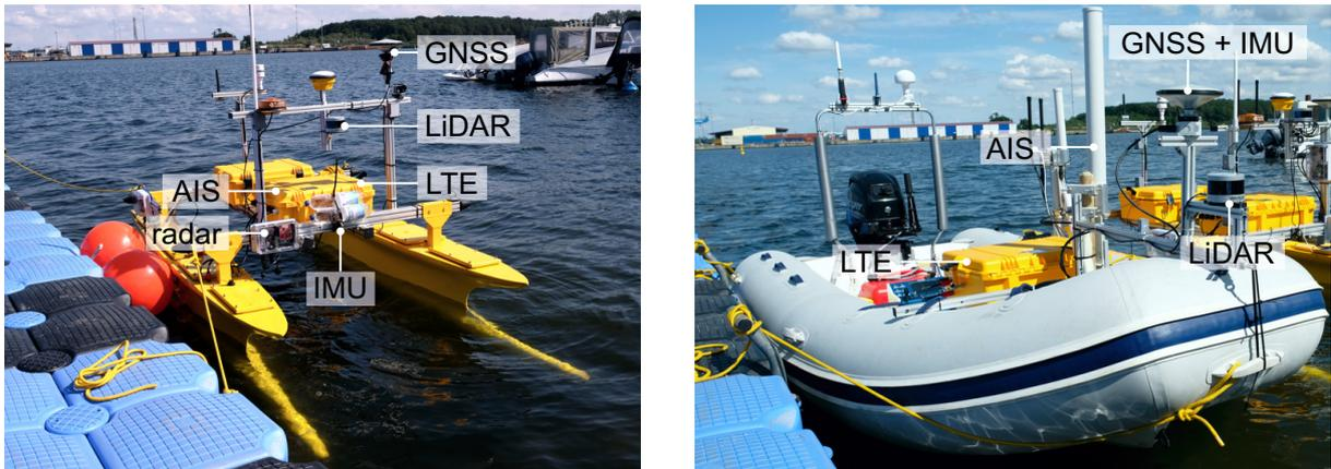
Abbildung 4.13: Versuchsaufbau links: Ausrüstungen auf dem MESSIN. Rechts: Sensorausrüstungen auf dem Schlauchboot, [67]; USV MESSIN und dargestelltes Schlauchboot sind Eigentum der Universität Rostock.
