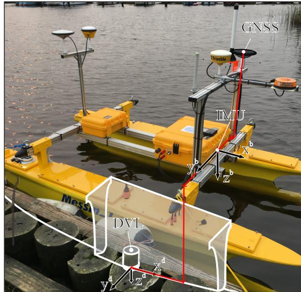
Abbildung 2.10: Unbemanntes Fahrzeug (USV) MESSIN, aus [11]; USV MESSIN ist Eigentum der Universität Rostock.
