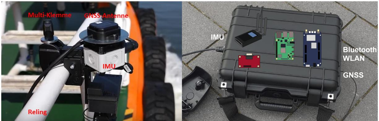
Abbildung 2.6: Sensorbox montiert an der Reling der "Weserlotse" (links) und Koffer mit den Hardwarekomponenten des mobilen Navigationsfilters (rechts)
