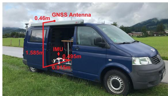
Abbildung 3.6: Messaufbau und Sensorverteilung am Testbus der IFEN GmbH, aus [38]
