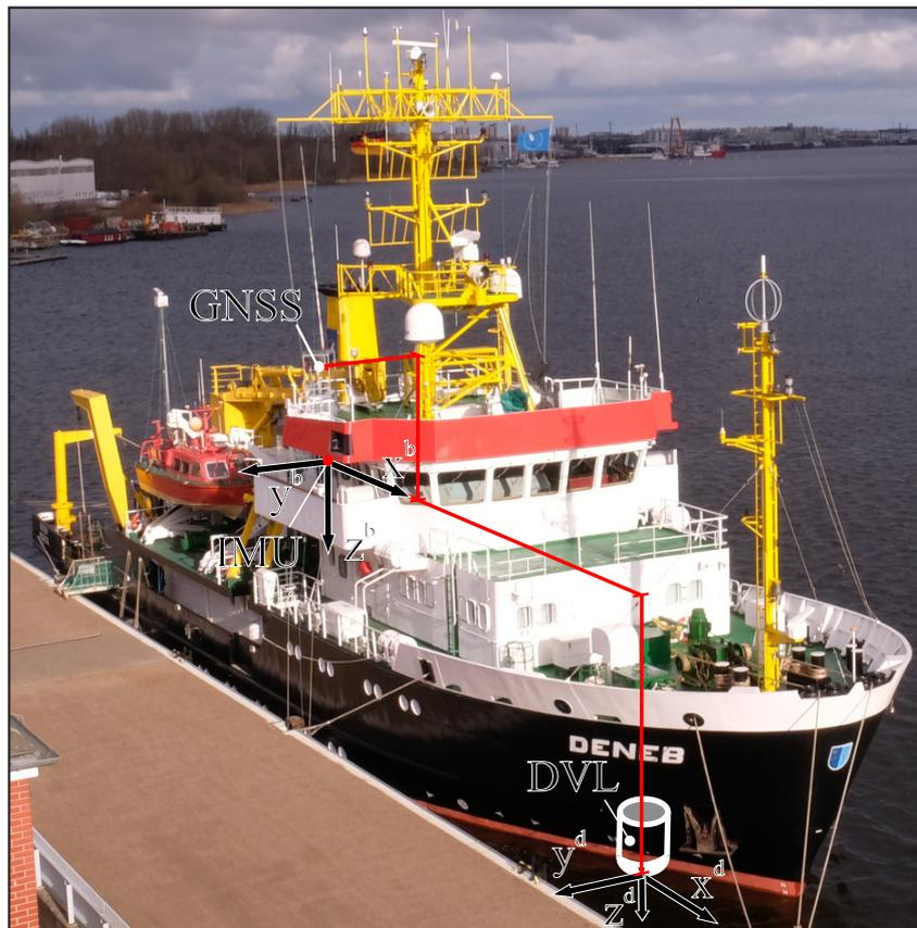
Abbildung 2.18: Forschungsschiff DENE B des BSH: Versuchsaufbau mit IMU, DVL und GNSS-Antenne, aus [11]
