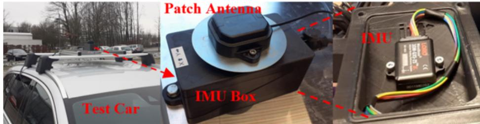
Abbildung 2.20: Messaufbau Versuchsfahrzeug für Validierung des tragbaren Navigationssystems, aus [27]
