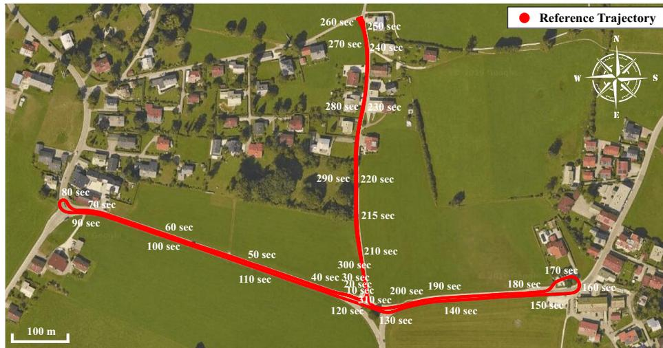
Abbildung 3.7: Referenztrajektorie unter Verwendung eines RTK-fähigen GNSS-Empfängers, ©2019 GeoBasis-DE/BKG (©2009), Google, aus [38]
