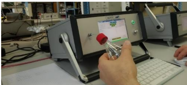
Abbildung 21: Beprobung eines Gasvolumens und Messung des IMS-Spektrums (STEP, Pockau)
