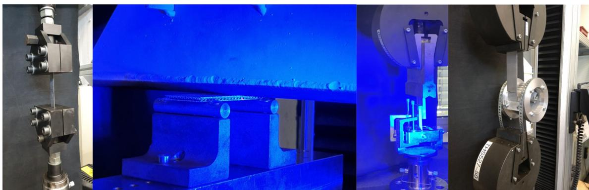
**Abbildung 5.39:** (von links nach rechts) Zug-, Biege-, Schub und Trommelschälversuch zur Validierung der homogenisierten FE-Verbundformulierung
