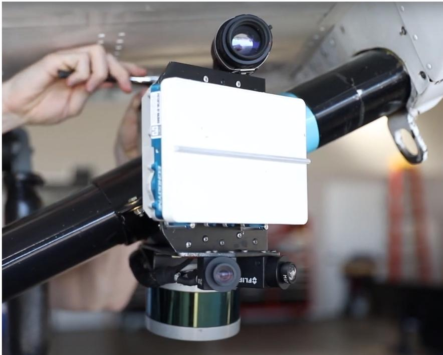
**Abbildung 5.71:** Detect-and-Avoid Sensorpaket von Xwing an einer Cessna C208 [3]
