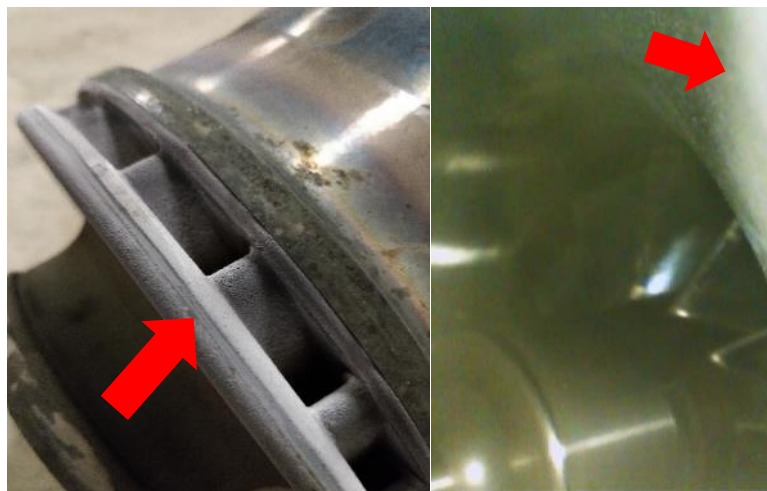
Abbildung 14: \text{SiO}_2 -Ablagerung an innenliegenden Bauteilen
