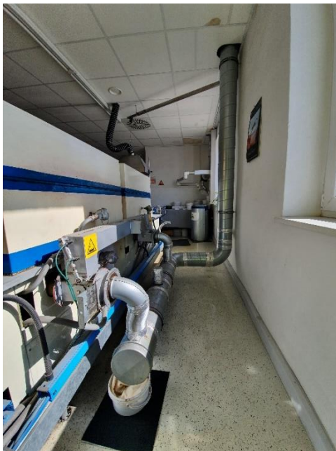
Abbildung 22: Laborbeschichtungsanlage (LABA) bei VOWALON (links), als Prüfstand „Abluftkonditionierung“ nach Integration eines Bypasses zur Abluftkühlung/-kondensation und Gasanalyse (rechts)
