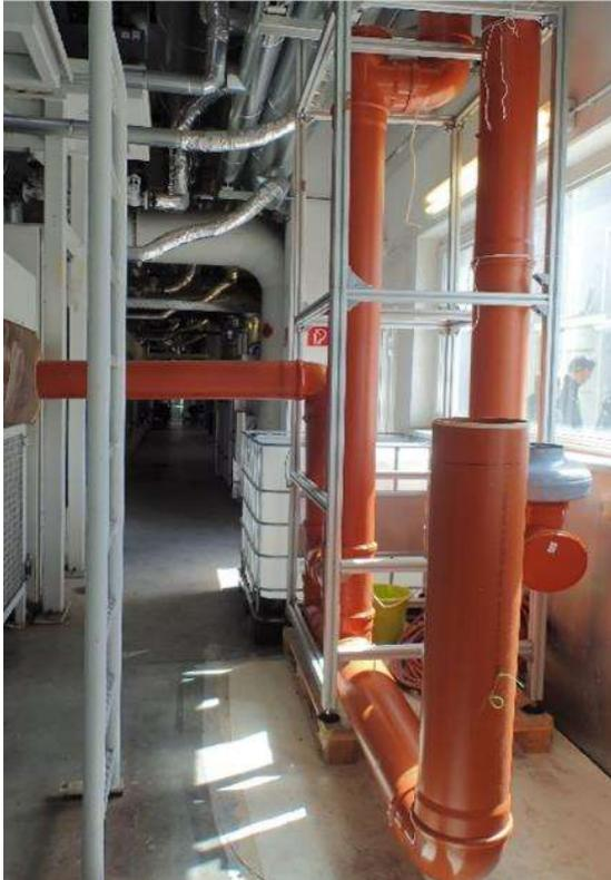
Abbildung 9: Versuchswäscher an der HOBA
