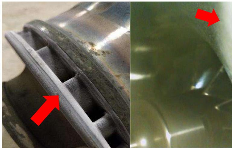
Abbildung 14:  $\text{SiO}_2$ -Ablagerung an innenliegenden Bauteilen
