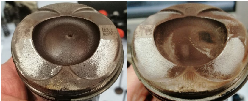
Abbildung 9 Kolbenkrone mit partiell weiß-grauen Ablagerungen
