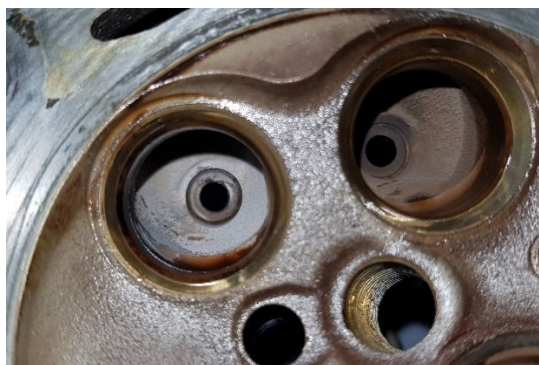
Abbildung 10 weiß-graue Ablagerungen in den Auslasskanälen
