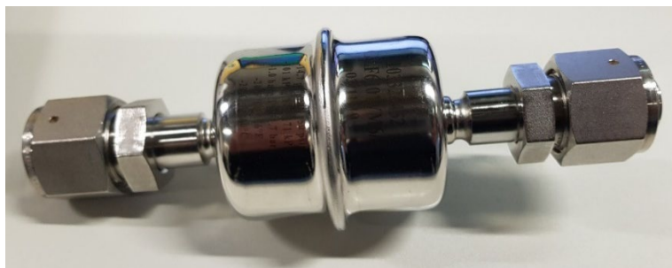
Abbildung 5 Messfilter zur Ölrückmessung
