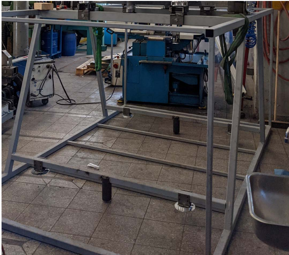
Abbildung 9: Gefertigtes Grundgerüst der Kabine.
