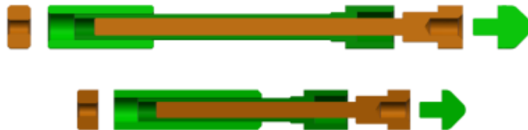
Abbildung 15: Pin der iBOSS-Schnittstelle (oben) und von upBUS.
