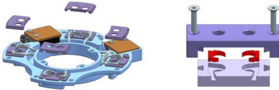
Abbildung 17: Strombox der iBOSS-Schnittstelle (links) und von upBUS.
