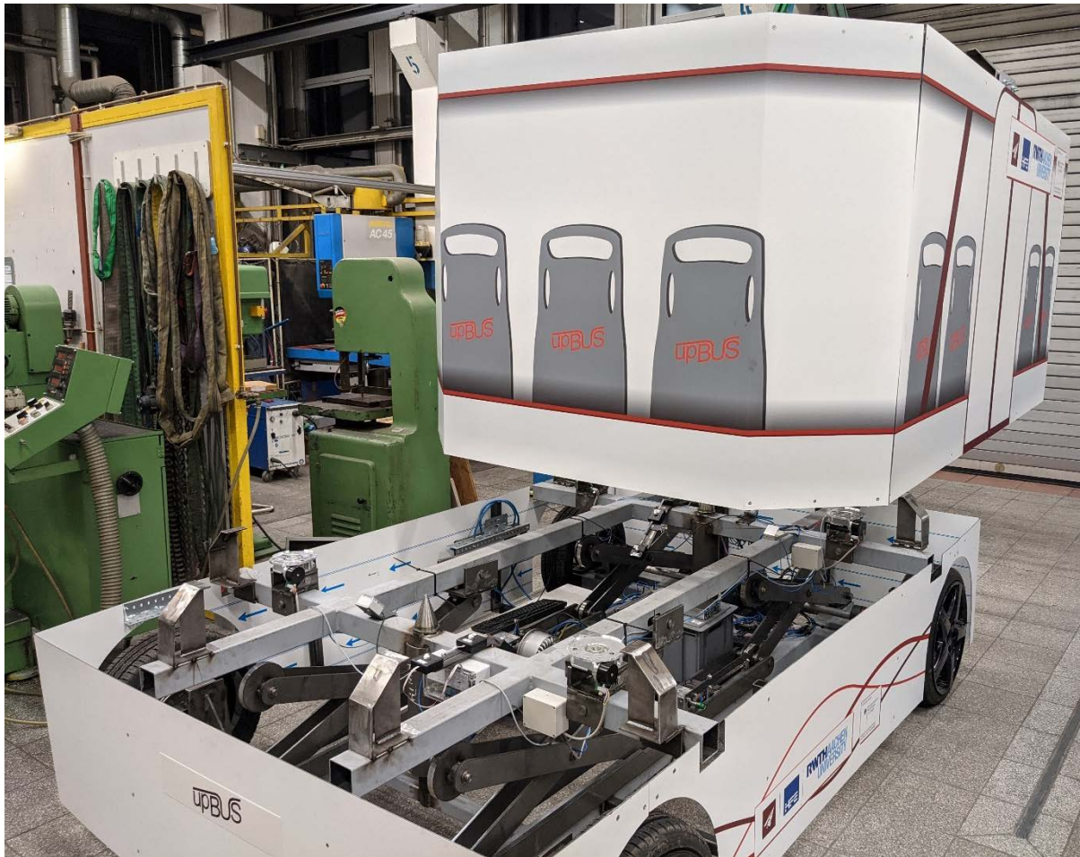
Abbildung 60: Zum Einstellen der Systeme am fertigen Fahrzeug wird ein Hallendeckenkran als Ersatz für die Seilbahnstation verwendet.
