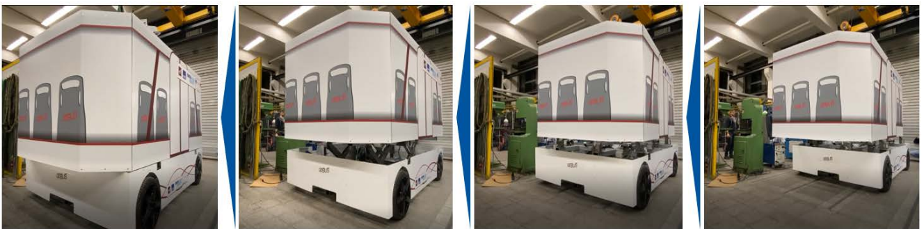
Abbildung 61: Der Proof-of-Principle im Werkstattumfeld. Die Bilderserie zeigt den Wechsel vom Seilbahn- in den Busmodus (von rechts nach links).
