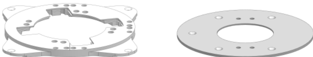
Abbildung 19: Auflagerring der iBOSS-Schnittstelle (links) und von upBUS.
