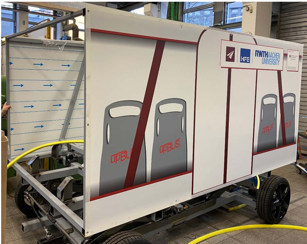
Abbildung 59: Montage der Karosserie.
