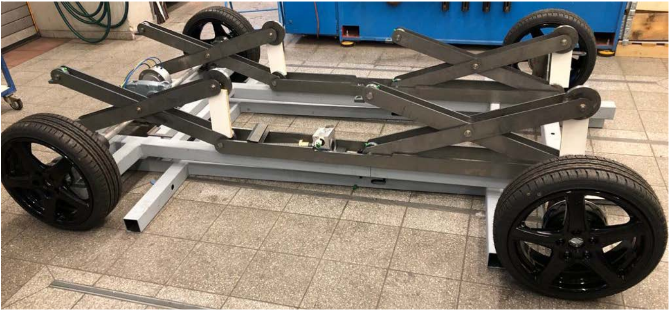
Abbildung 44: Grundgerüst des Fahrmoduls mit montierten Reifen, Antriebseinheit und der Unterseite des Hubsystems. Die obere Ebene des Hubsystems liegt auf dem Boden unterhalb des Fahrmoduls.
