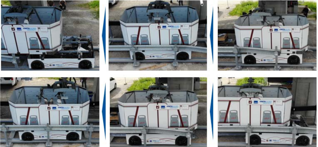
Abbildung 63: Proof-of-Principle am Seilbahnteststand. Die obere Bilderserie zeigt den Wechsel vom Bus- in den Seilbahnmodus (von rechts nach links). Die untere Bilderserie zeigt den Wechsel vom Seilbahn- in den Busmodus (von rechts nach links).
