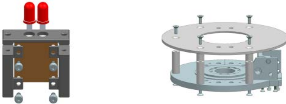
Abbildung 16: Spacer der iBOSS-Schnittstelle (links) und von upBUS.
