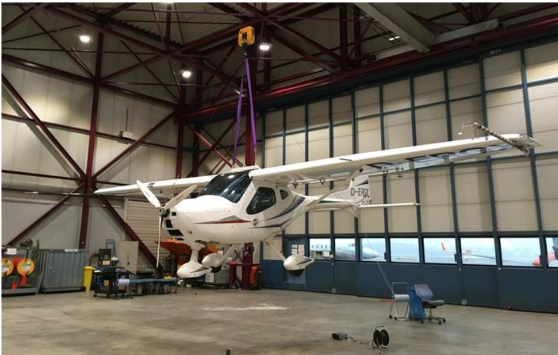
Abbildung 20: Beispielhafter Versuchsaufbau zur Bestimmung der Massenträgheitsmomente der RemosGX
