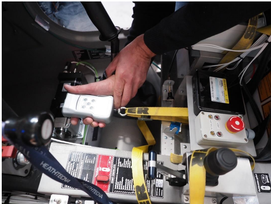
Abbildung 11: Belastungsversuch einer eingebauten Komponente
