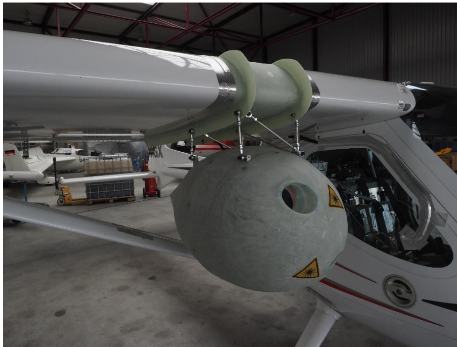
Abbildung 13: Eingebauter Pod mit Cover
