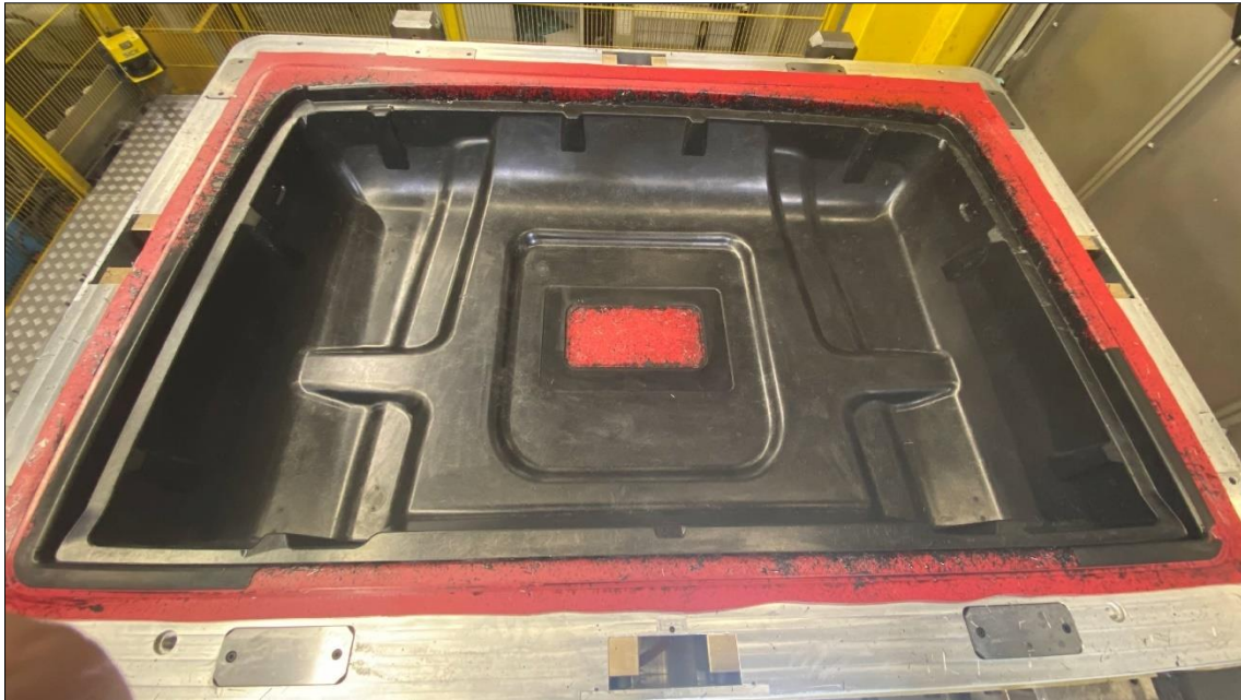
Abbildung 90: Im Werkzeug eingelegte ABS-Tiefziehfolie mit darauf eingetragenen und verpresstem LFI sowie darin integriertem Schaumkerneinleger
