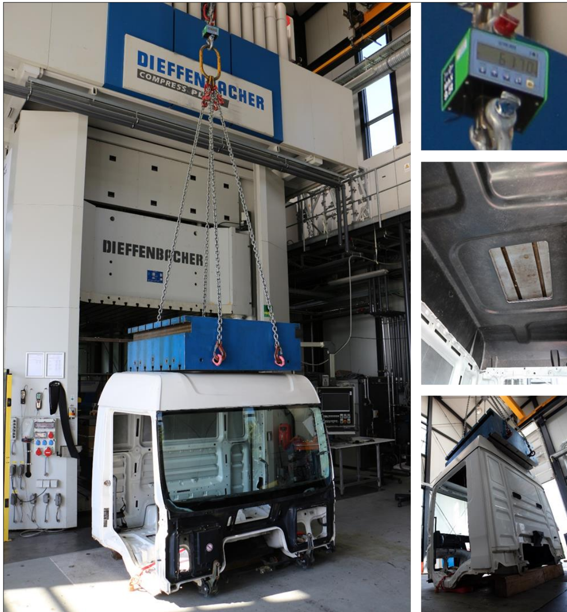
Abbildung 105: Hochdach-Demonstrator „HylightCab“ mit aufgelegtem Prüfgewicht und Innenansicht
