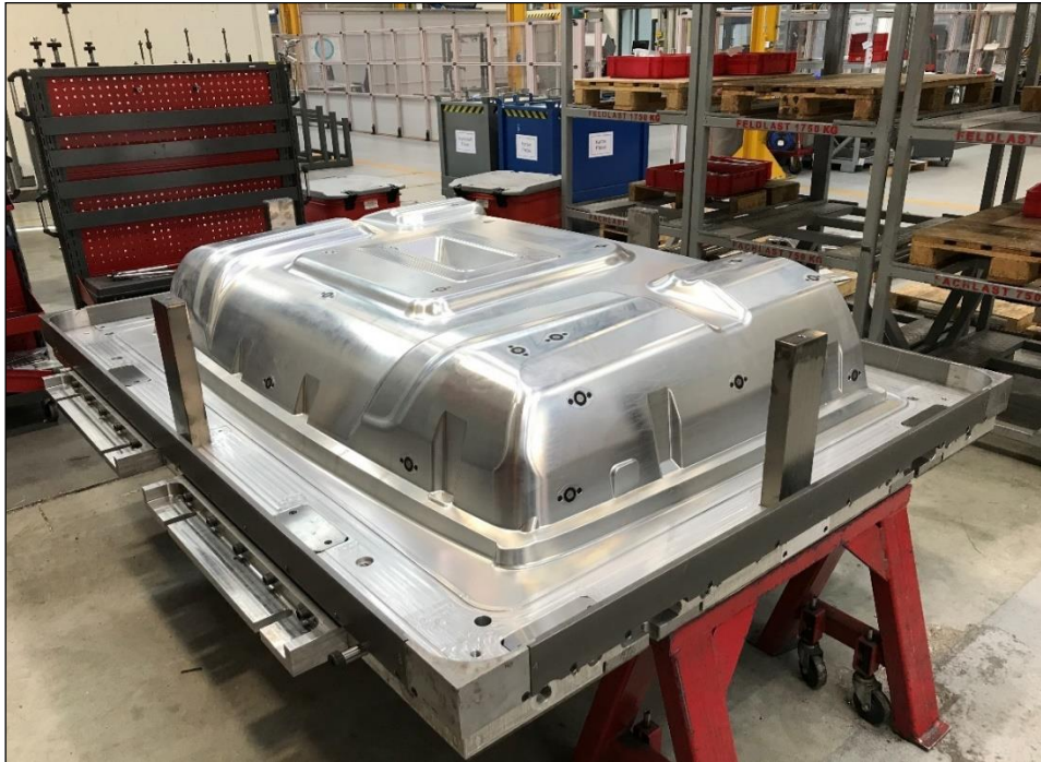
Abbildung 86: Aus dem Konzept überführte, bei Siebenwurst gefertigte Patrize des Demonstratorwerkzeugs
