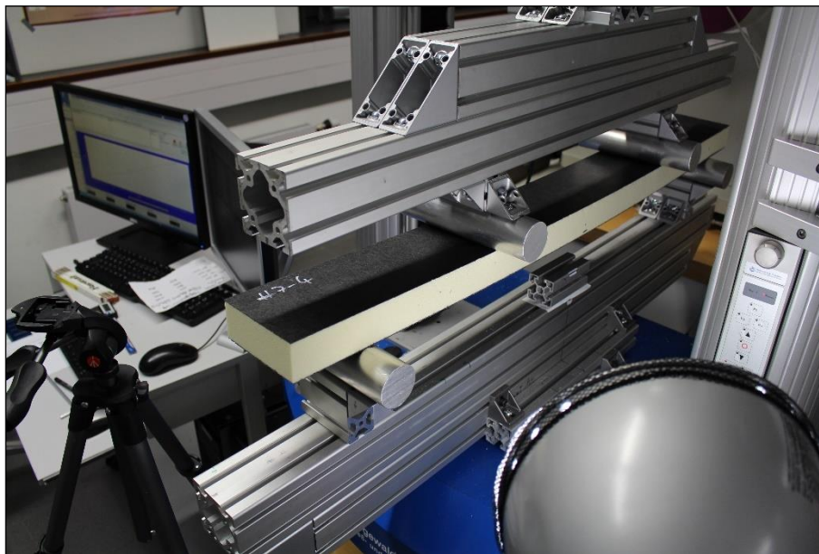
Abbildung 17: Universalprüfmaschine Hegewald & Peschke mit 4-Punkt-Biege-Vorrichtung und Kernverbundprobe nach DIN 53 293
