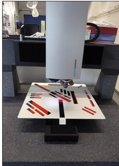
Abbildung 34: Oberflächencharakterisierung der Class-A-SMC-Referenzprobe
