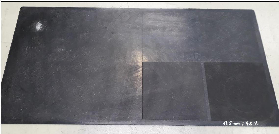
Abbildung 39: Prüfkörperplatte mit oberflächenmodifizierten Teilbereichen
