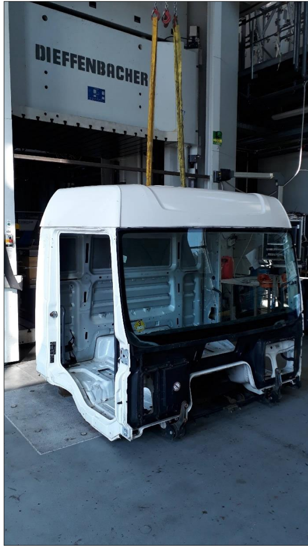
Abbildung 100: Kabinenrohbaurahmenstruktur links und aufgesetzter Hochdach-Demonstrator rechts
