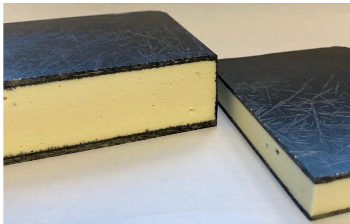
Abbildung 64: Hergestellte Platten für Materialvalidierung
