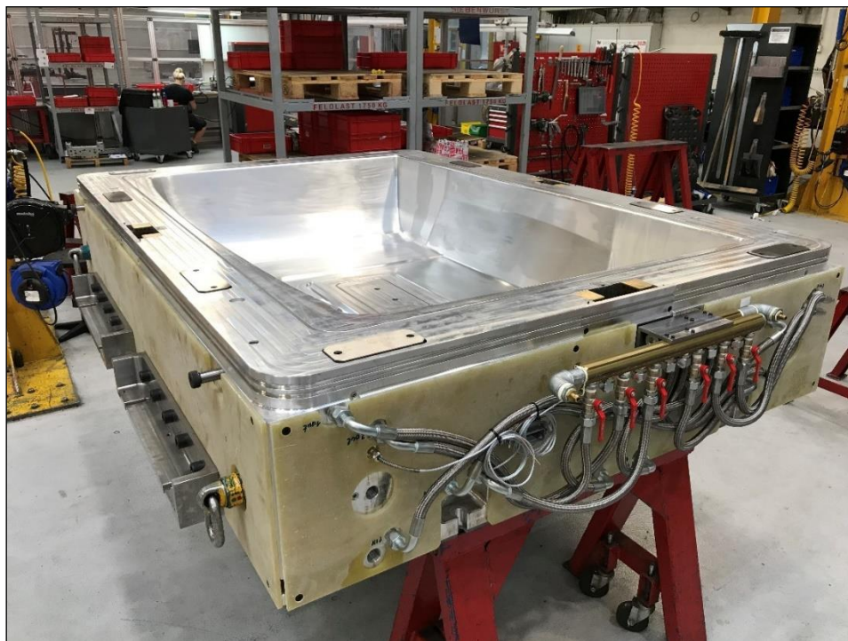
Abbildung 87: Bei Siebenwurst gefertigte Matrize des Demonstratorwerkzeugs
