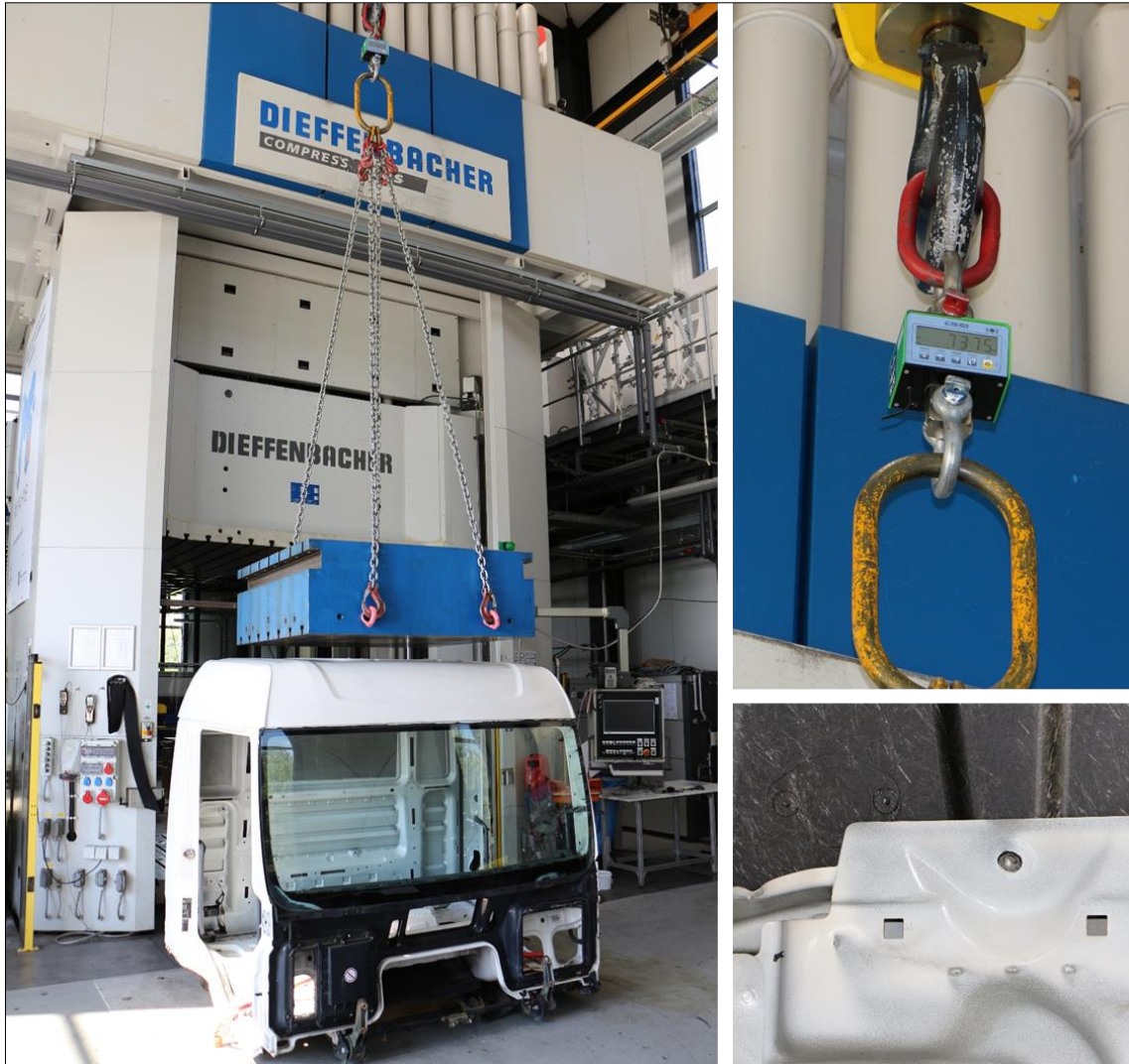
Abbildung 104: Prüfstands Aufbau „HylightCab“ mit Prüfungsgewicht, passgenauer Dachverschraubung und Abdichtungsflächen
