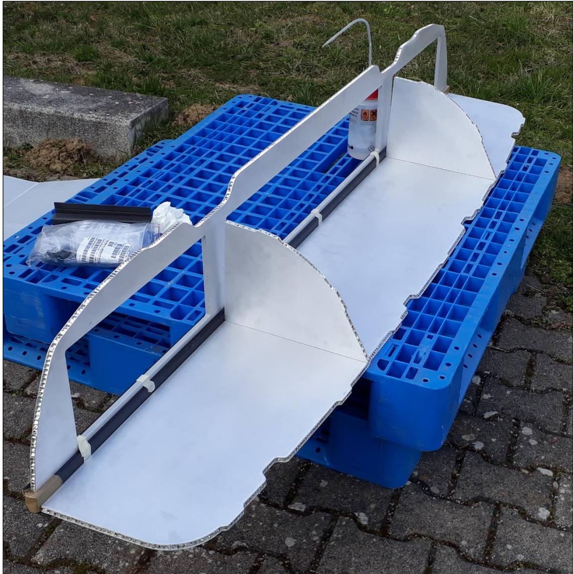
Abbildung 98: Verklebung und Anpassung der Staufach-Sandwichpanelen mit dem Pultrusionsprofil
