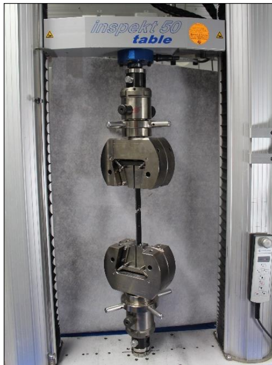
Abbildung 31: Zugprüfvorrichtung und Prüfung einer LFI-Probe nach DIN EN ISO 527-1
