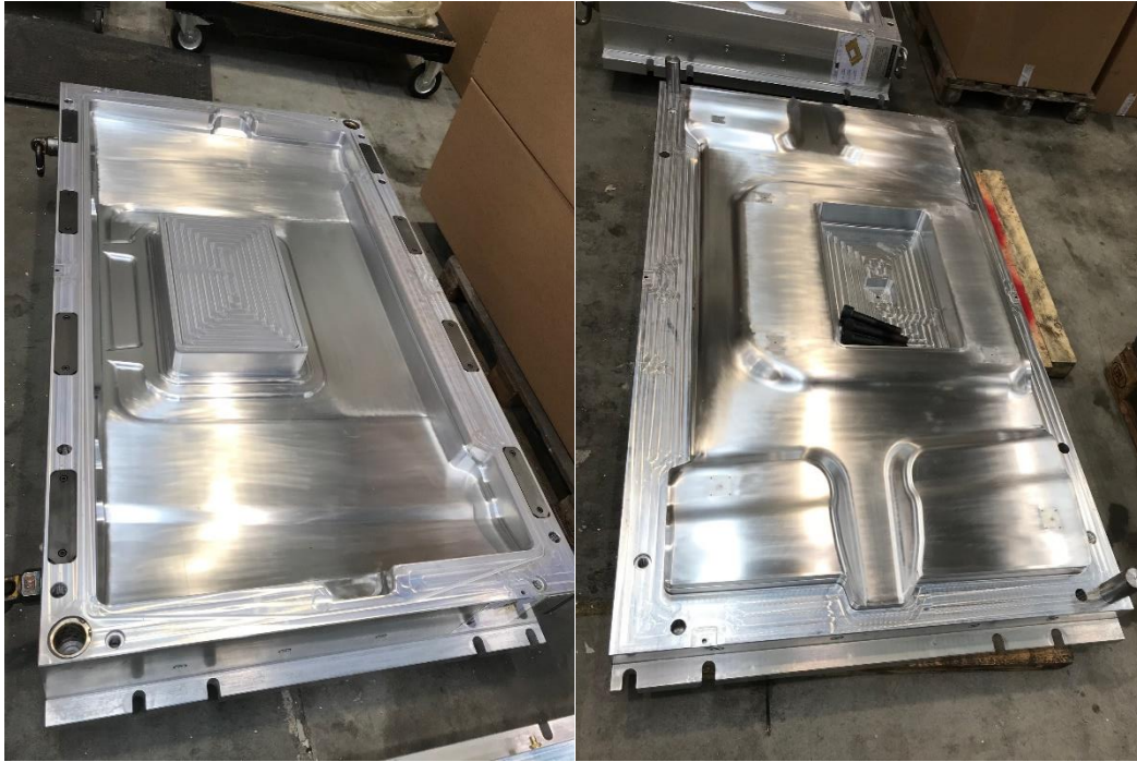
Abbildung 78: Die Formhälften eines der Schaumkernwerkzeuge nach der Politur
