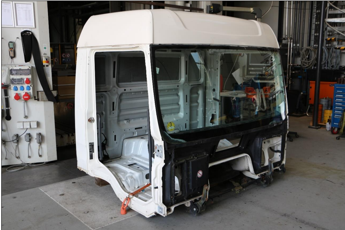
Abbildung 101: Prüfstands Aufbau mit aufgesetztem Demonstrator
