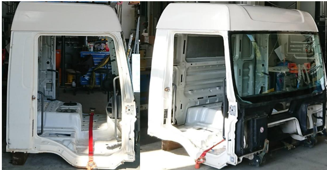
Abbildung 94: Validierung Passgenauigkeit Hochdach
