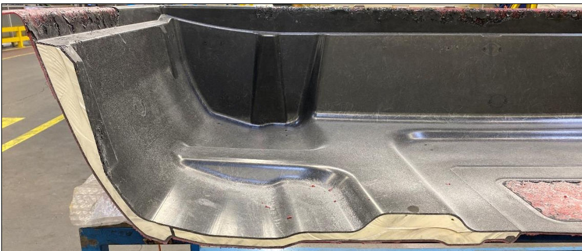
Abbildung 91: Querschnitt durch ein gefertigtes Demonstratorbauteil
