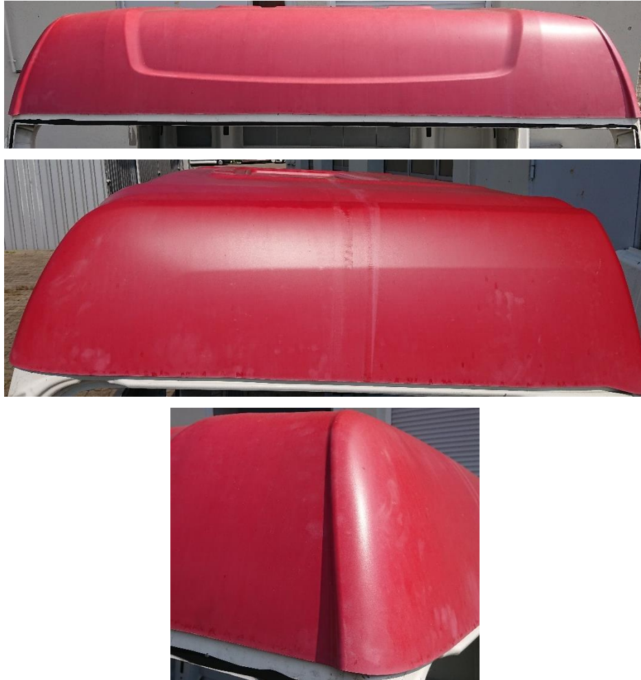
Abbildung 93: Auswirkungen von Witterungseinflüssen auf den Prototyp der ersten Abmusterung
