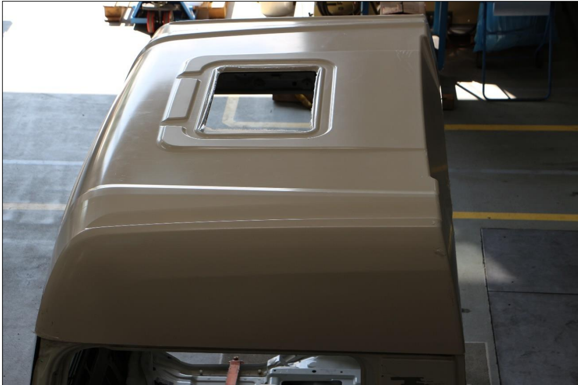
Abbildung 103: „HylightCab“-Demonstrator mit ausgefräster Luke für das Ausstelldach
