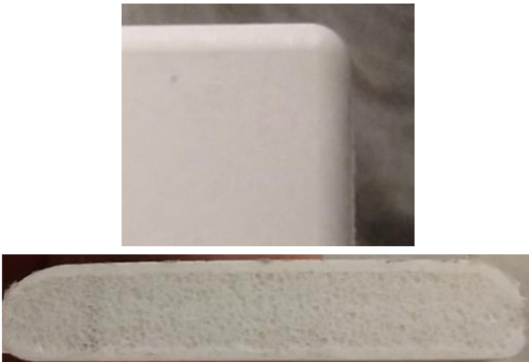
Abbildung 2-41: Oben: Abbildung einer von SMC umflossenen Schaum-Ecke, unten: Schnittbild durch eine Probeplatte mit drei unterschiedlichen Kantenradien zur Begutachtung der Materialanbindung zwischen SMC und Schaumkern
