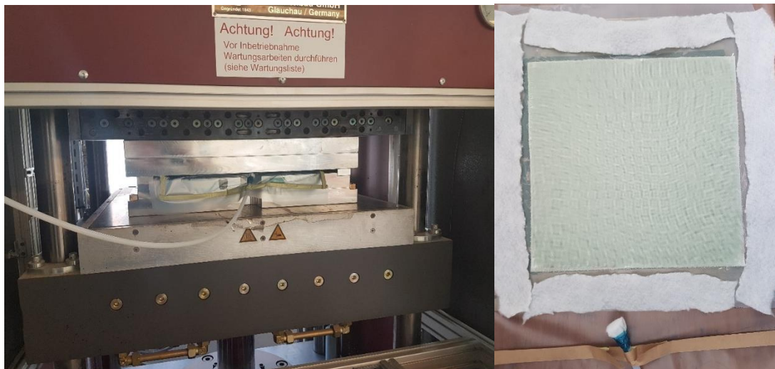
Abbildung 2-17: Links: Aushärtung einer Probe in der Heizpresse, Laminat im Vakuumsackaufbau
