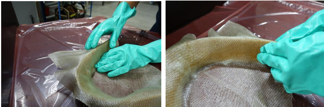
Abbildung 2-39: DirectPreg-Halbzeuge bieten eine hervorragende Drapierfähigkeit
