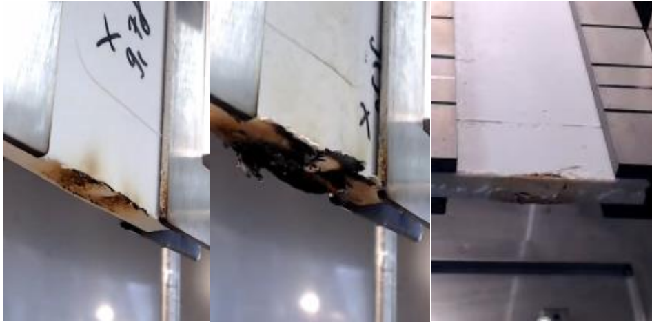
Abbildung 2-6: Brandtestergebnisse zur Entflammbarkeit nach FAR 25.853 an Sandwich-SMC-Probekörpern: 12 Sekunden-Vertical Burn Test (links), 60 Sekunden-Vertical-Burn-Test (mittig), 15 Sekunden-Horizontal-Burn-Test (rechts)
