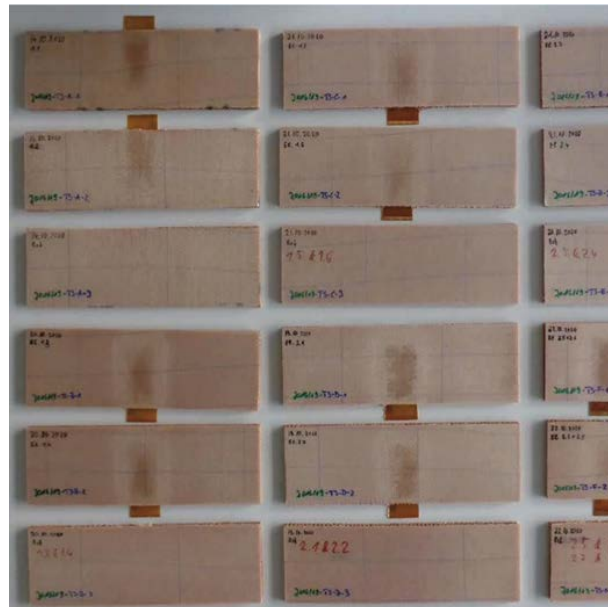
Abbildung 13: Eine Auswahl der von der TUHH hergestellten ersten Testcoupons, welche die von der TU Dresden beigestellten Elektronikkomponenten integriert haben. Diese so hergestellten Proben wurden zur Charakterisierung und zum Test an die TU Dresden und an die IMA Materialforschung und Anwendungstechnik GmbH geliefert.
