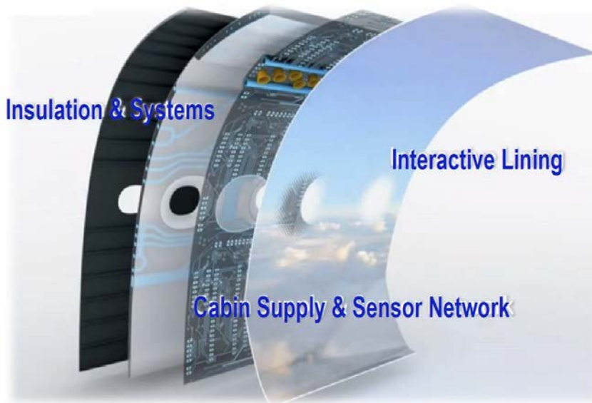
Abbildung 3: Darstellung aus dem Video [2] „Imagine Innovations Flying Tomorrow“ des BDLI zu so genannten aktiven Oberflächen.
