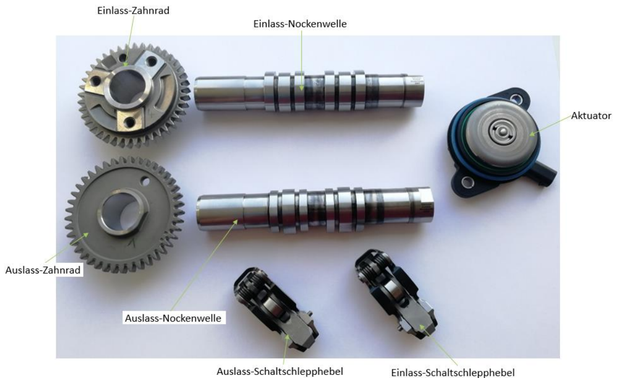
Bild 2: Komponenten des Schaeffler eRocker-Systems
