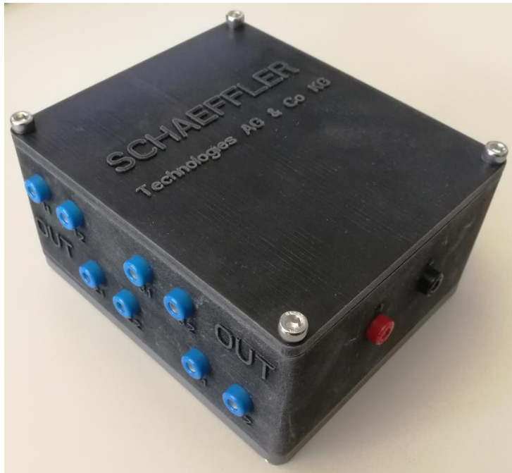
Bild 4: Steuergerät eRocker-System für Namosyn
