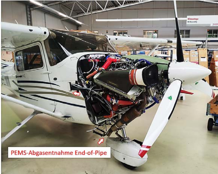
Abbildung 6.93: Aufbau und Integration der PEMS-GA ins Flugzeug des Typs Cessna172 ausgestattet mit einem CD170 am Flughafen Leipzig-Altenburg (I)
