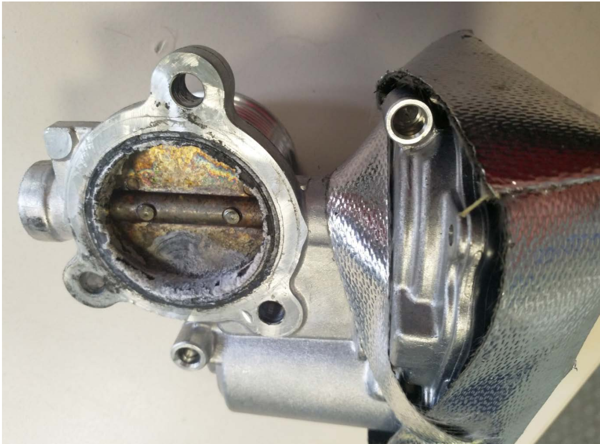
Abbildung 6.82: Versottung des AGR-Stellventils
