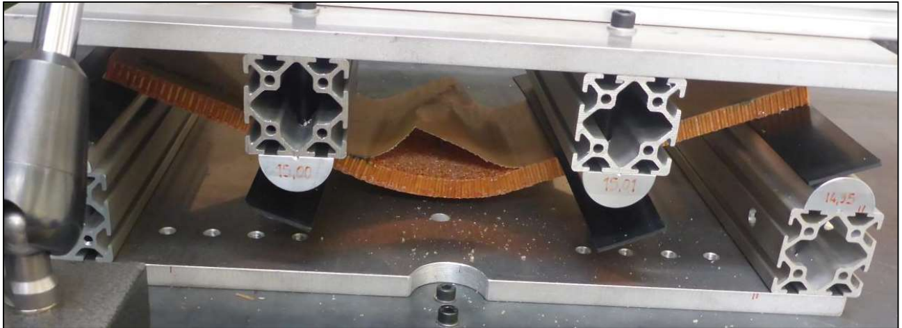
Bild 1.34: Biegeversuch mit Testcoupon J016/19-TS-A-3
