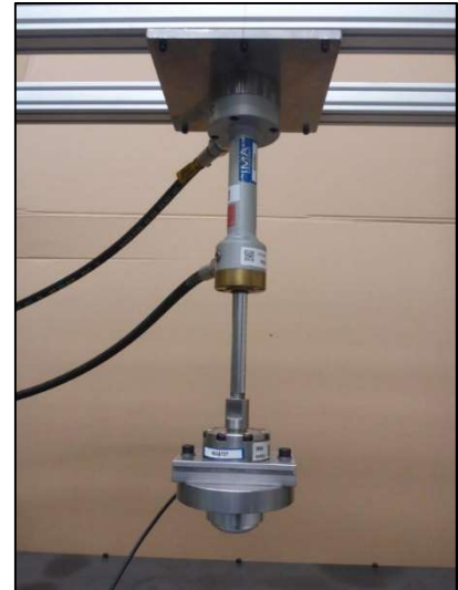
Bild 1.5: Prüfstand, Lasteinleitung Druckversuch mit Kalotte R = 37,5mm (final)
