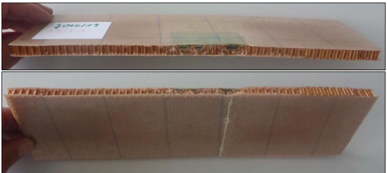
Bild 1.45: Schaden an J016_19-TS-I-1
