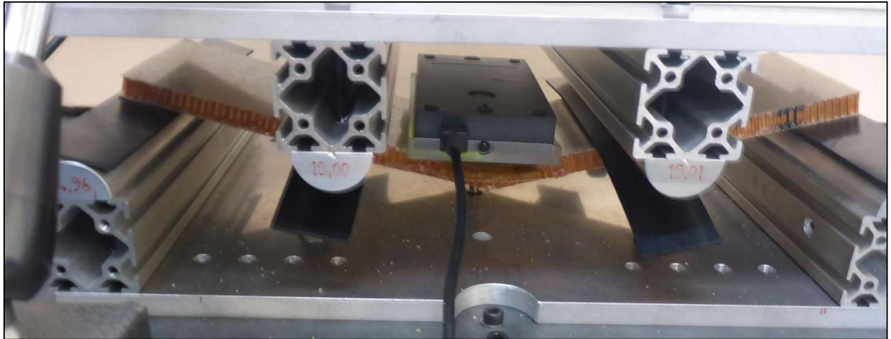
Bild 1.32: Biegeversuch mit Testcoupon J016/19-TS-A-2
