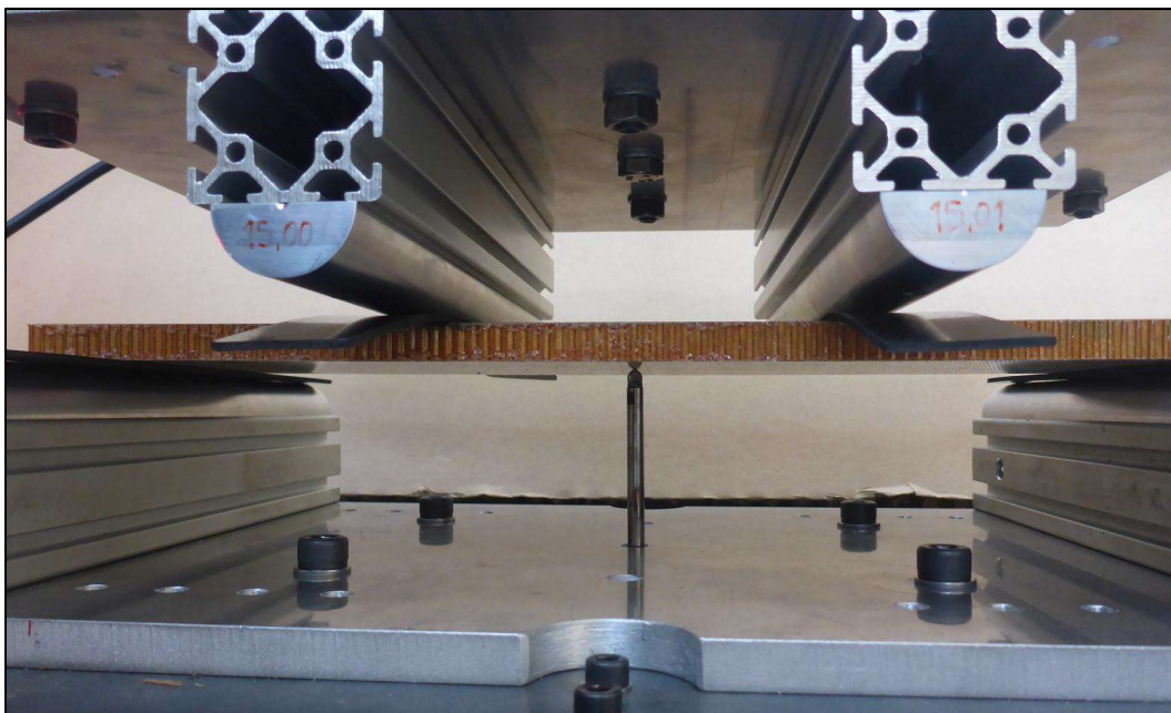
Bild 1.29: Biegeversuch mit Testcoupon (dünn), modifizierter Aufbau, Detail
