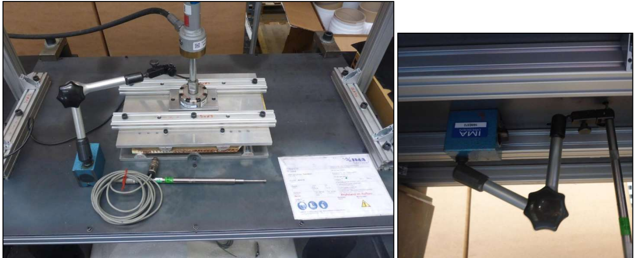
Bild 1.8: Versuchsaufbau V0, Biegung
