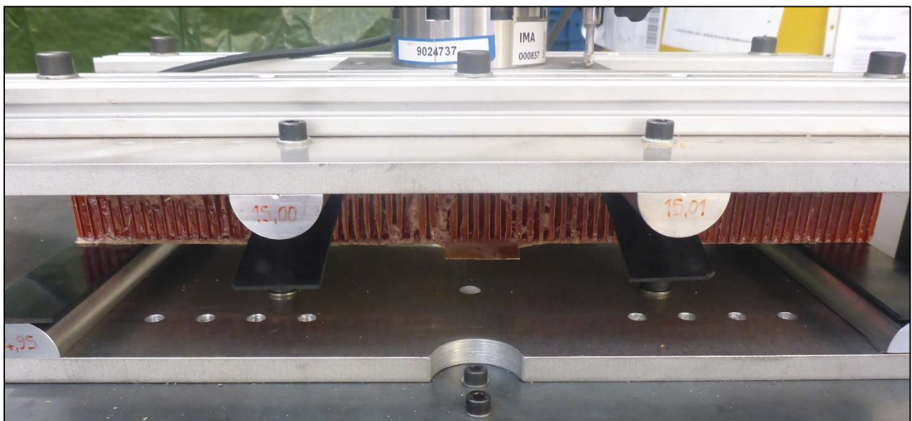
Bild 1.23: Biegeversuch mit Testcoupon (dick)
