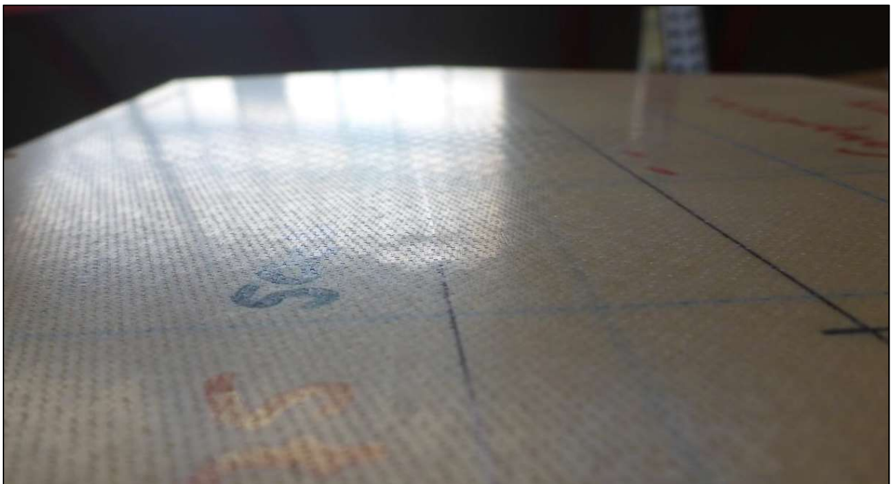
Bild 1.14: Test #3: Abdruck bei Druckkraft F [N]: 500
