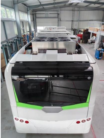
*Abbildung 27: Bus mit Wärmepumpe*
