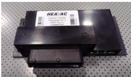
Abbildung 21: CAN-Controller AC HCP
