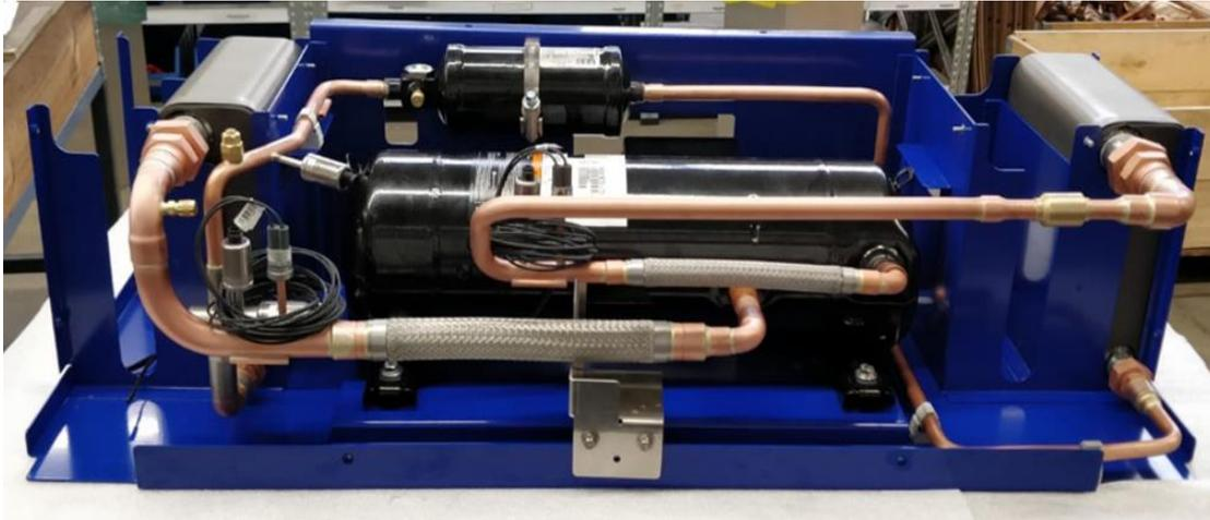
Abbildung 13: Versuchsaufbau der Messanlage (Kältemittelkreis)
