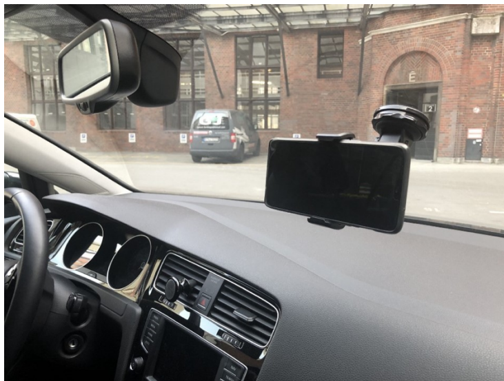
Abbildung 2: Aufbau zur Erhebung von Bildbefahrungsdaten. Ein Smartphone wird mit einer Handyhalterung an der Frontscheibe befestigt und nimmt aus der Beifahrerperspektive den rechten Straßenrand auf.
