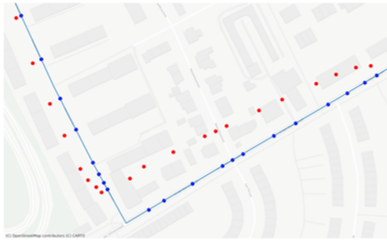
Abbildung 6: Beispiel für Fehlerkorrektur durch Map-Matching. In Rot abgebildet sind die aufgezeichneten Geodaten während der Fahrt und in Blau ist die Fahrt nach der Korrektur abgebildet. © OpenStreetMap-Mitwirkende © Carto
