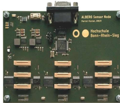
Abbildung 5: Hauptplatine der Sensorknoten mit 9 bestückten Anschlüssen für Sensorplatinen
