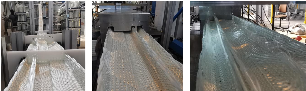
Abbildung 51: Faserzuführung (li: Vorausrichtung der Halbzeuge; mi: Einlauf; re: Werkzeugausgang)
