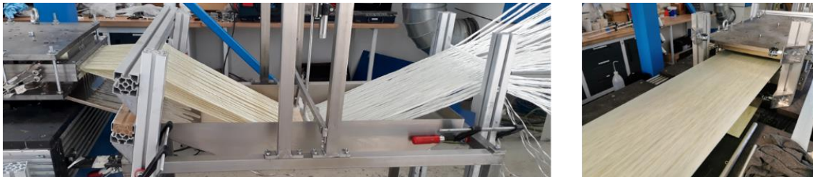
Abbildung 18: Herstellung von Prüfmustern (li: Fasertränkung und -einlauf; re: pultrudierte Prüfplatte)
