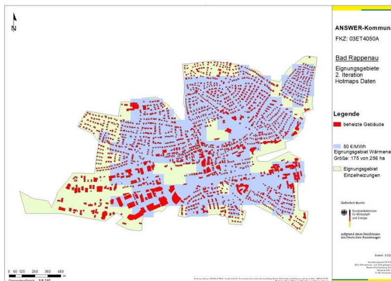
Abbildung 162: Ausdehnung der Eignungsgebiete beim hohen Spielraum der Wärmeverteilungskosten in der Stadt Bad Rappenau.
