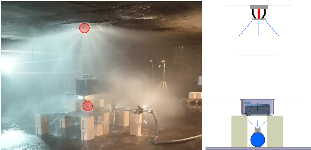
Abbildung 33: Versuchsaufbau „BDC von Unten + Sprinkler“
