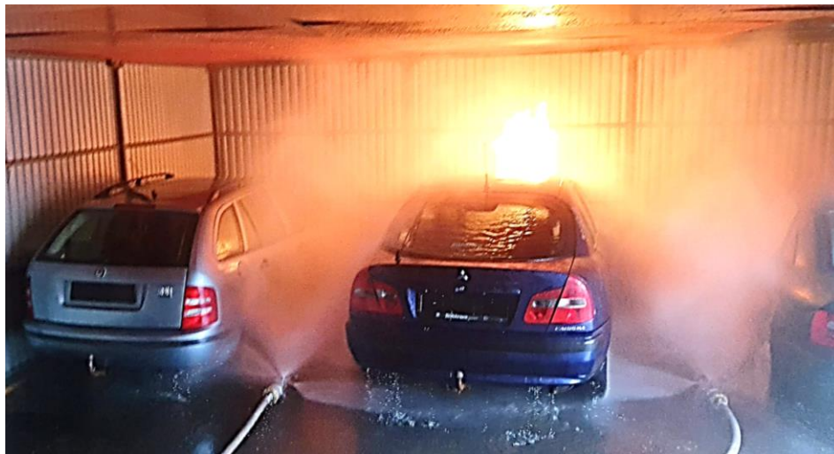
Abbildung 25 Handlings-Test des Bondary Cooling Device in Schweden
