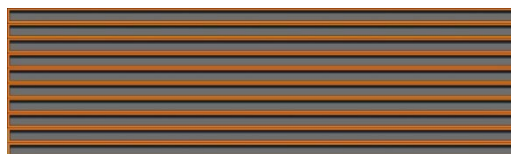
Abb. 49: Schematischer Querschnitt eines Stapels aus 10 REBCO-Bändern, die einen Leiteraufbau wie in Abb. 48 dargestellt haben. Die Supraleiterseite der Bänder befindet sich jeweils oben. Die Dimensionen sind nicht skaliert!
