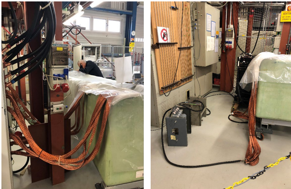
Abb. 81: Messaufbau mit Stromzuführung für DC-Messungen (links) und für AC-Lorentzkrafttest (rechts).
