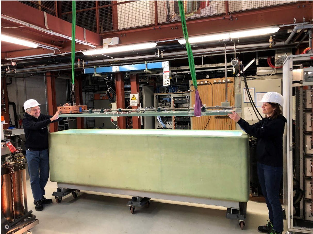
Abb. 79: Einbau des Kabeldemonstrators in Kryowanne.
