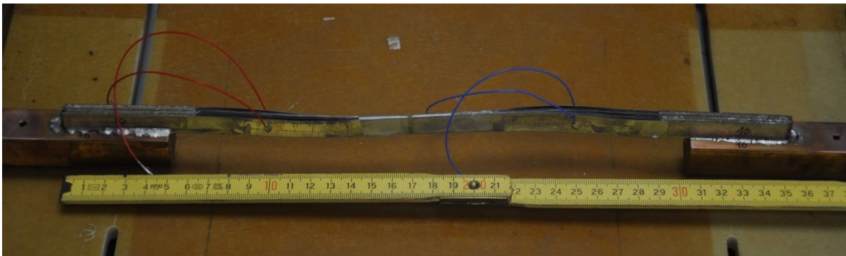
Abb. 51: Seitliche Stromspeisung in einen Bandstapel aus zehn etwa 150 \mu\text{m} dicken REBCO-Bändern der Firma THEVA. Im Kontaktbereich wurden zusätzlich 500 \mu\text{m} dicke Cu-Bänder zwischen die REBCO-Bänder gelegt, um die seitliche Kontaktfläche zu vergrößern. Anschließend wurde der Stapel seitlich in die Nut eines Cu-Blocks eingelötet.
