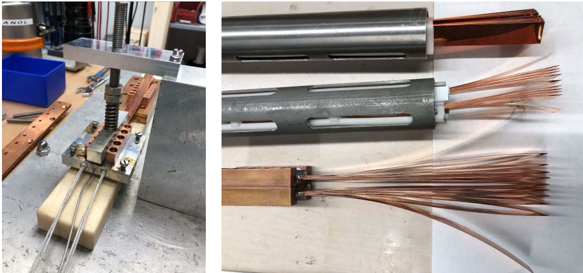
Abb. 74: Einlöten eines Bandstapels in den Cu-Block für die Kurzschlussverbindung (links) und bestückte Kabelkomponenten vor dem Verlöten der 90°- und 180°-Verbindungen (rechts).
