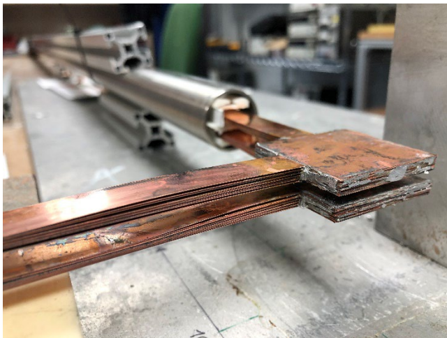
Abb. 76: 90°-Verbindungen beim Hin- und Rückleiter nach dem Verlöten.
