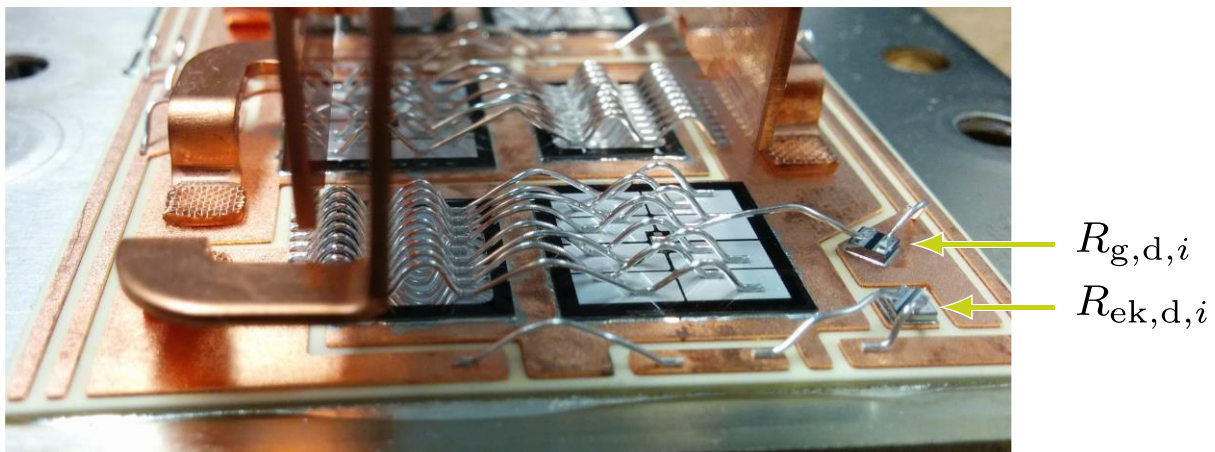
Abbildung 10: Foto der diskreten Widerstände in einem geöffneten IGBT Leistungsmodul FF1000R17IE4D_B2 [2]
