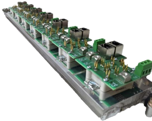
Abbildung 45: Vorbereitetes Kühlsystem, Module und Ansteuerung für die Alterungstests im Fraunhofer IISB
