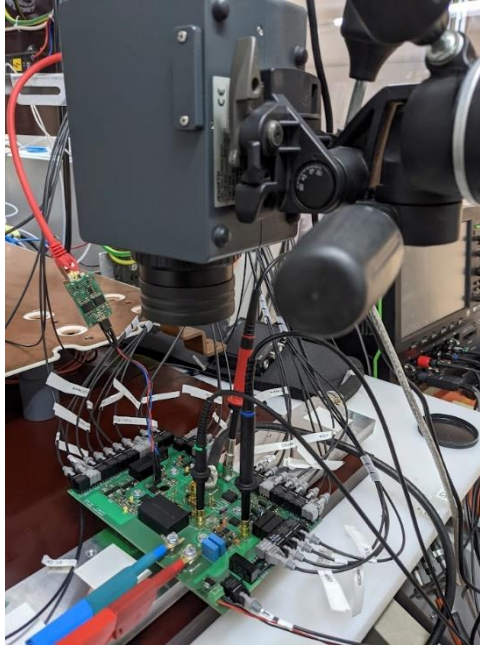
Abbildung 39: Aufbau der Temperaturmessung mit IR Kamera
