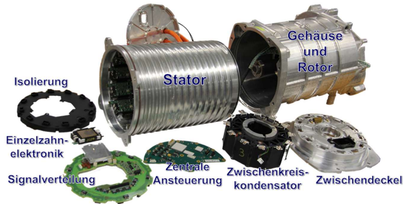
Abbildung 11: Zerlegter EMiLE-Antrieb
