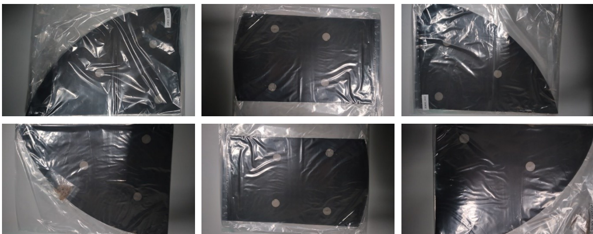
Abbildung II.1.4-41: hergestellte 6 Segmente einer hochskalierten Schaumelektrode
