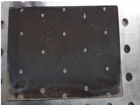
Abbildung II.1.5-5: Lieferzustand mit Kontaktierungs-löchern des zweiten mit RaNi beschichteten Ni-Schaum
