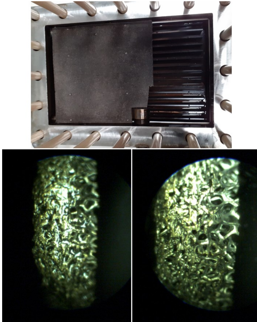
Abbildung II.1.4-24: geschnittene unbeschichtete Ni-Schaumkathode mit eingebauter Endoskopkamera (oben); Aufnahmen der porösen Elektrodenstruktur innerhalb der Zelle vor der Elektrolyse (unten)
