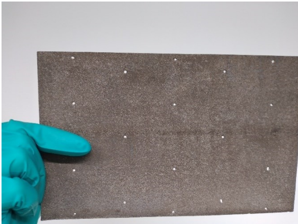
Abbildung II.1.5-9: Lieferzustand mit Kontaktierungs- löchern des zweiten mit NiMn be- schichteten Ni-Schaum
