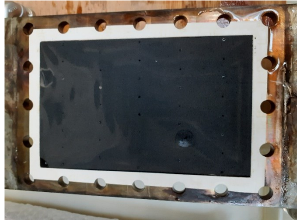
Abbildung II.1.5-12: Zustand des mit RaNi beschichteter Ni-Schaum nach dem Dauertest im Setup 21
