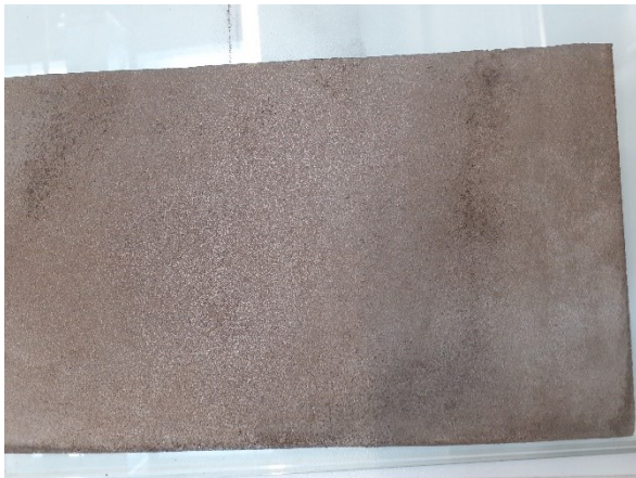
Abbildung II.1.5-13: für den Dauertest im Setup 21 aus einem Elektrodensegment zugeschnittener mit NiMn beschichteter Ni-Schaum
