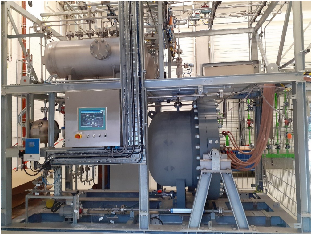
Abbildung II.1.4-40: 145 kW-Druckelektrolyseur im H2FZ des Lehrstuhl KWT an der BTU C-S
