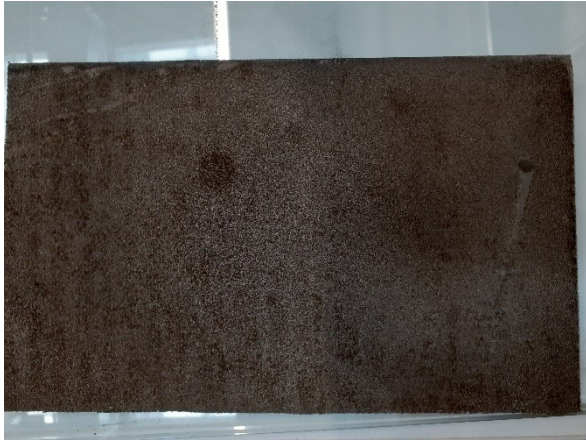
Abbildung II.1.5-11: für den Dauertest im Setup 21 aus einem Elektrodensegment zugeschnittener mit RaNi beschichteter Ni-Schaum
