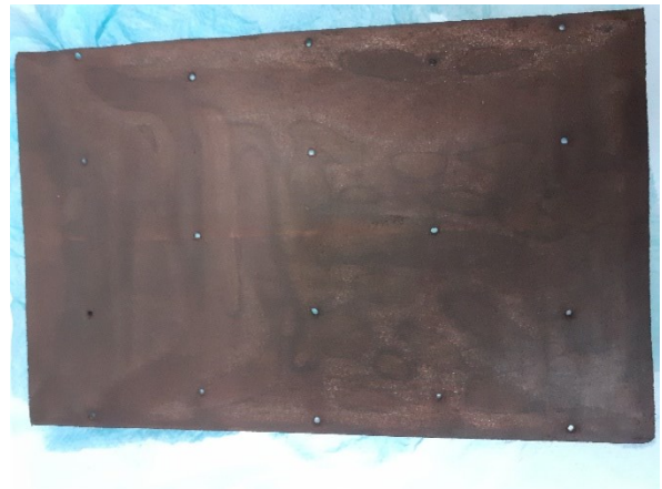
Abbildung II.1.5-10: Zustand des zweiten mit NiMn be- schichteten Ni-Schaum nach dem letzten Test im Setup 10
