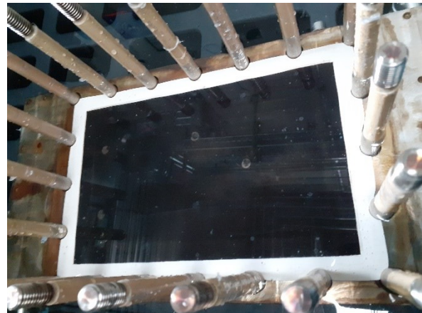
Abbildung II.1.5-4: Zustand des ersten mit RaNi beschichteten Ni-Schaum nach dem letzten Test im Setup 16
