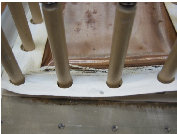
Abbildung II.1.3-11: Risse in der Zirfon™ UTP 500+ nach dem Test im Setup 04
