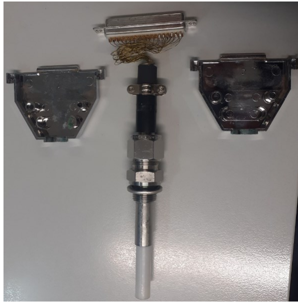
Abbildung II.1.4-32: innerer Aufbau des konzipierten Potentialsensors
