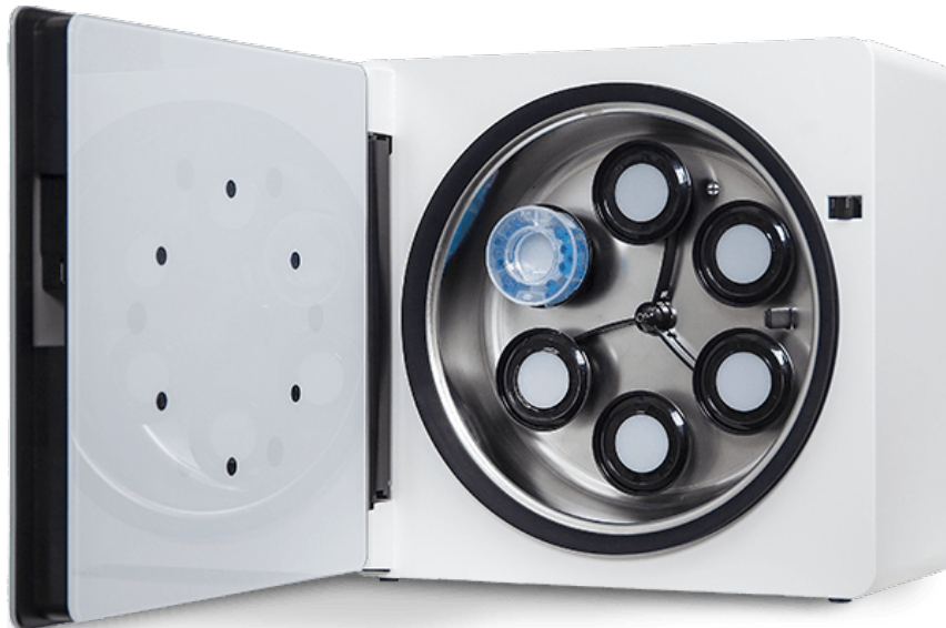
Abbildung 60: Der ClinoStar mit einem Clinoreactor (Bildquelle: https://celvivo.com/wp-content/uploads/2021/07/Clinostar_transparent_02.png , © CelVivo)
