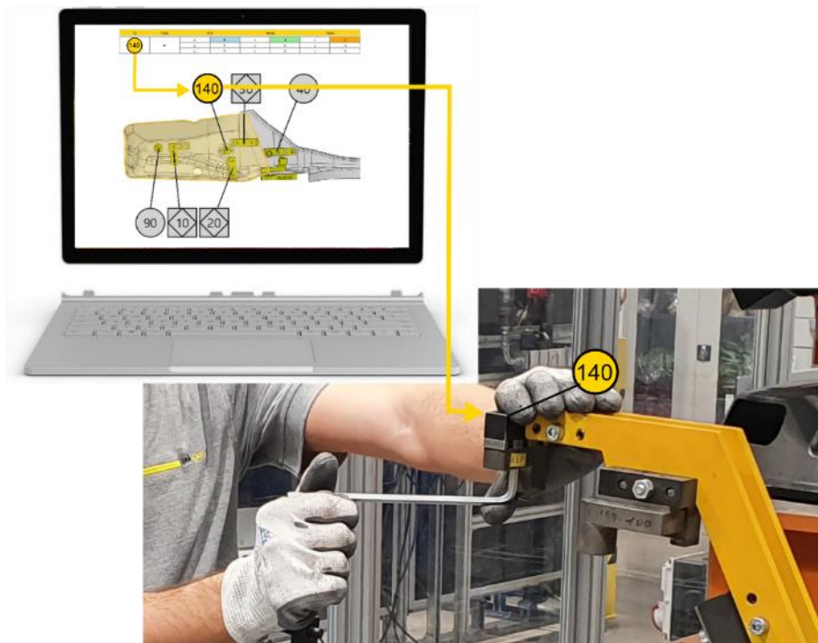
Abbildung 12: Stellmaßnahmen an der Rohbauanlage koordiniert über das Digitale Shimsbuch der inigence gmbh
