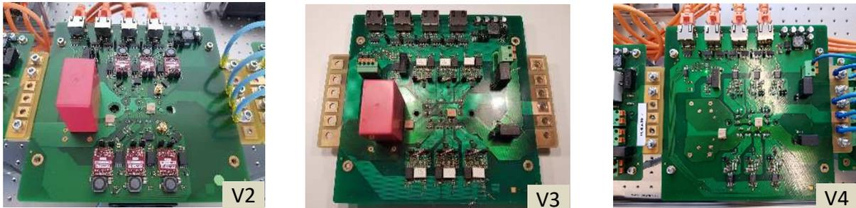
**Abbildung 26: Entwicklungsschritte des SiC Inverter**
