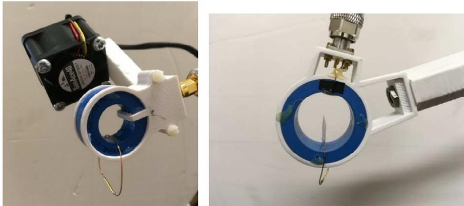
Abbildung 87: Forciert gekühlte HF-Stromzange IP-Ide3AL-ActiveCool-001 (links), IP13 (rechts)
