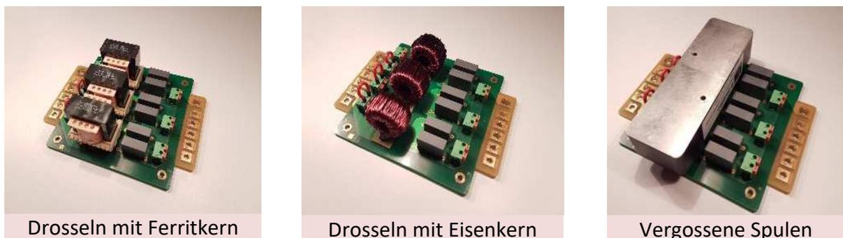
**Abbildung 27: Unterschiedliche Ausführungen des Sinus-Ausgangsfilters**
