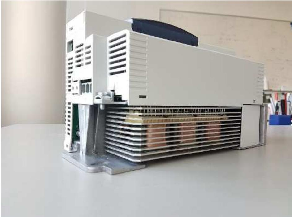
**Abbildung 23: Muster des Umrichters inkl. der Integration des EI-Kern Filters**
