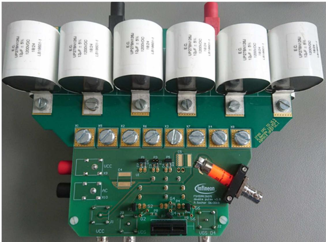
Abbildung 52: Doppelpulsplatine zur Charakterisierung des SiC MOSFET Leistungsmoduls
