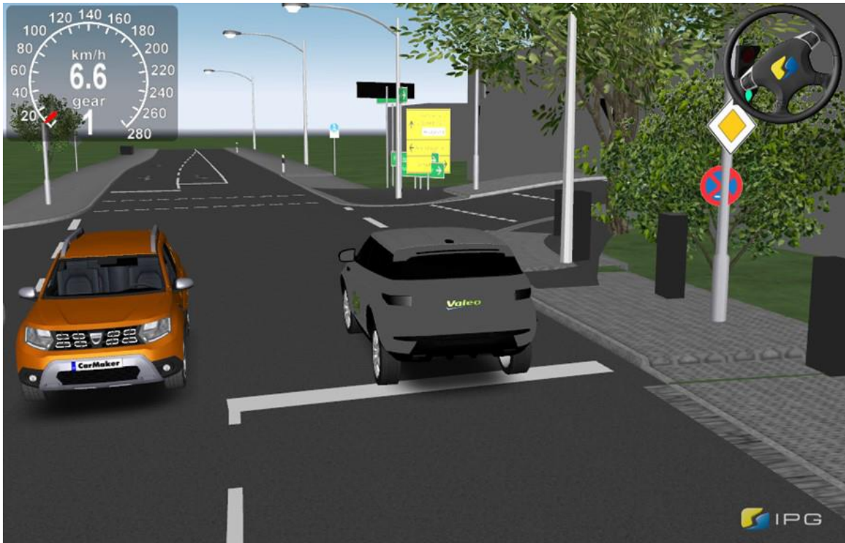
Abbildung 59: Simulation des Vorgangs Links-Abbiegen an einer Kreuzung mit Gegenverkehr ohne separater Abbiegespur unter Verwendung der von 3D-Mapping generierten HD-Karte von Kronach
