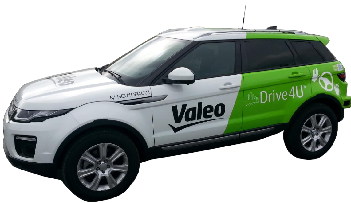
Abbildung 51: Versuchsträger PKW Range Rover Evoque 2.0 4WD Automatik (SD4 BVA Dynamic), Baujahr 2018, 1999 ccm, Benzin, 177 kW, 1746 kg, Radstand 2660 mm, Länge 4370 mm
