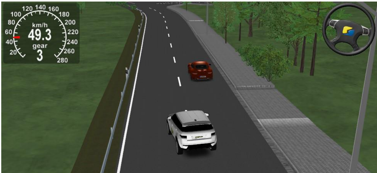
Abbildung 58: Erprobung des Engstellen Szenarios in der Simulationsumgebung IPG Car Maker
