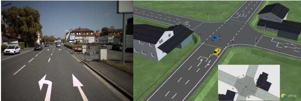
Abbildung 67: Erprobung des Manöverplaners an der Kreuzung Siechenangerstraße / Rodacher Straße in Kronach im realen urbanen Umfeld und nach vorheriger Simulation in IPG Car Maker
