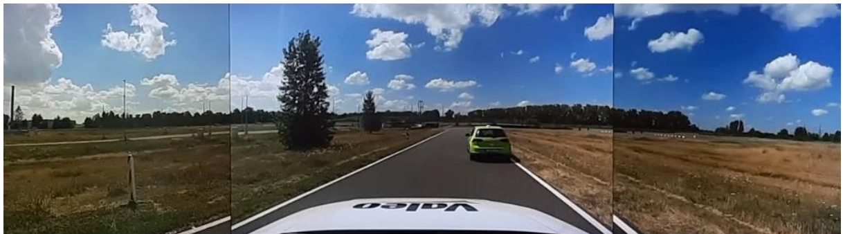
Abbildung 54: Surround-View-Ansicht während der Vorbeifahrt an einer Engstelle durch einen liegen gebliebenem PKW
