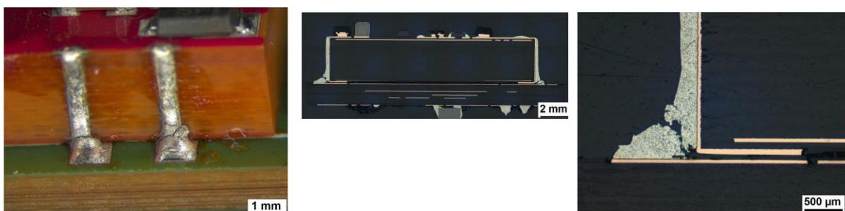
Abbildung 25: Huckepackplatine mit Rissbildung nach Temperaturwechselbelastung (2700 Zyklen)
