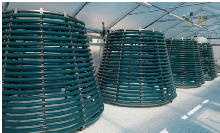
Abbildung 4: Tannenbaum-Photobioreaktorsystem (Tannenbaum-Lichtkollektor-Module (TLM) [1])
