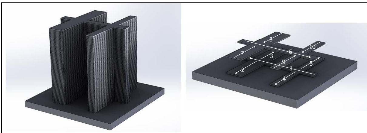
Abbildung 23: Lagenförmiger Aufbau und Bahnplanung der H-Probe
