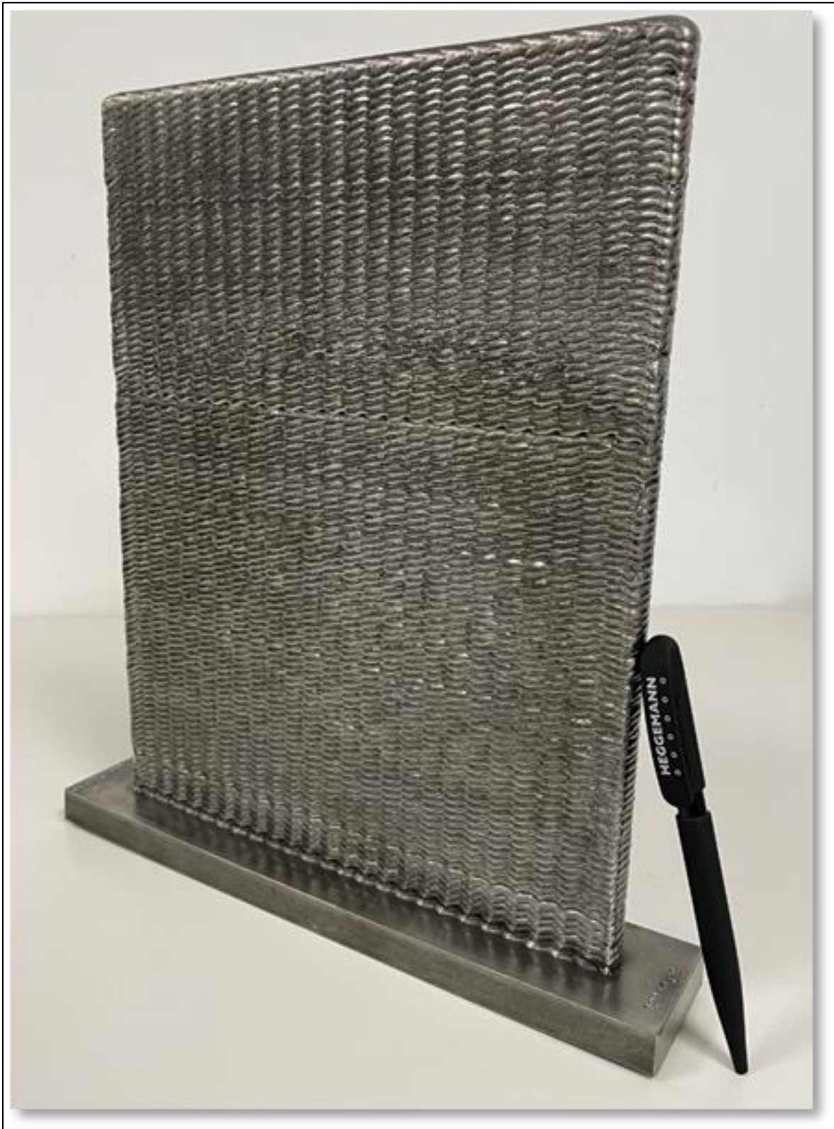
Abbildung 29: WAAM-Demonstrator der HEGGEMANN AG zur Darstellung der sehr hohen Schweißqualität
