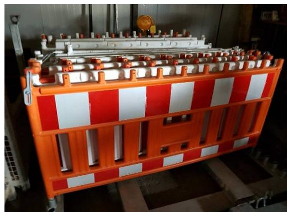
**Abb. 2:** Beispiele zu lokalisierender Baustellengeräte. Die Anwendungsbereiche der Lokalisierung reichen über eine große Bandbreite an Funktionalitäten wie der Erfassung der Nutzungszeiten, Diebstahlschutz, Wiederauffindung und Protokolliernachweise.
