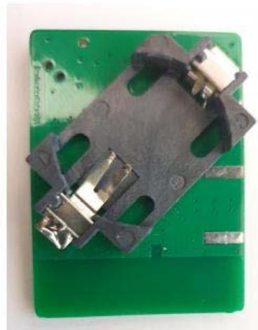
**Abb. 8:** PCB der Sender-Platine mit Komponenten bestückt.
