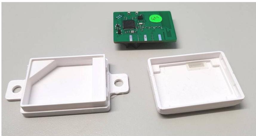
**Abb. 9:** Tag-Gehäuse, gedruckt in FDM-Technik.
