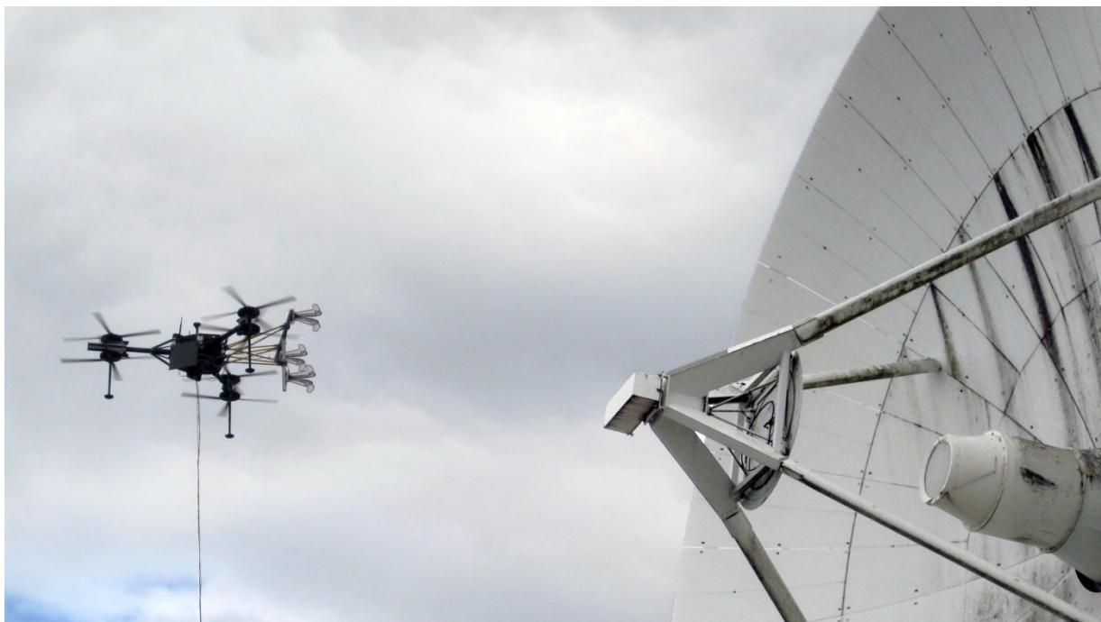
Abbildung 4-6: Messdrohne während phasenlosem Abtasten des elektromagnetischen Nahfeldes der GSOC S67 Antenne in Weilheim
