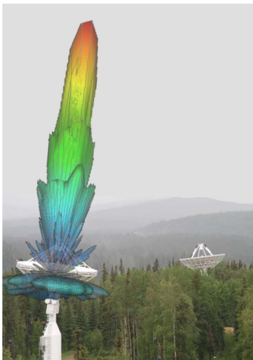
Abbildung 8-1: Messtechnische Verifikation des 3D Antennen-Fernfeldes einer Satellitenbodenstationsantenne basierend auf LARISSA Technologien
