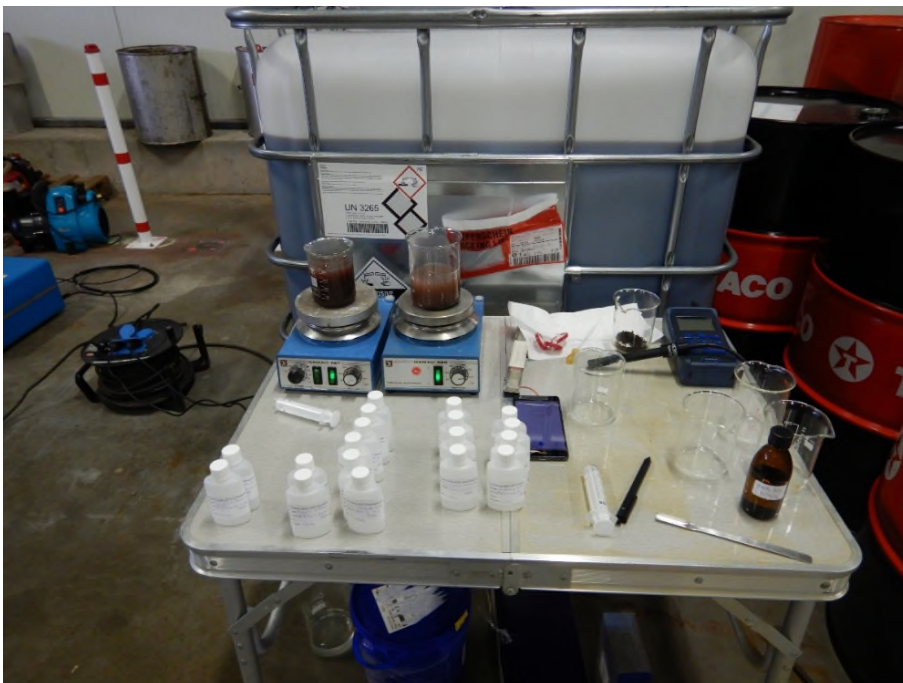
Abbildung 8: Durchführung der Vor-Ort Batch Experimente mit Thermalwasser nach Wärmetauscher und den Filtermaterialien Zeolith und GEH.
