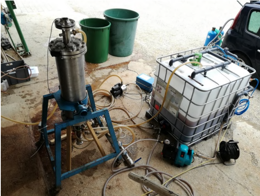
Abbildung 3: Erster Testeinsatz und Dichtigkeitsprüfung des HydroGeoFilt Filtersystems auf dem ausgelagerten Firmengelände der Firma Hydroisotop.
