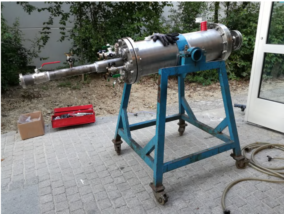
Abbildung 2: Aufbau des HydroGeoFilt Filtersystems auf dem Firmengelände der Hydroisotop.
