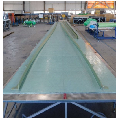
Abbildung 21: Tisch mit zweigeteilten Steg-Profilen
