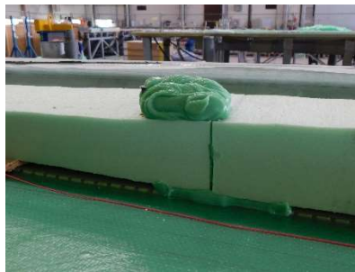
Abbildung 47: Auftrag von Klebharz zur Abstandsbestimmung
