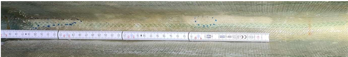
Abbildung 169: Während des Betriebs gewachsene Delamination an der Hinterkante
