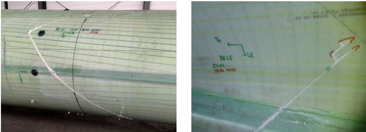
Abbildung 92: Strukturell kritischer Riss an der Nasenkante
