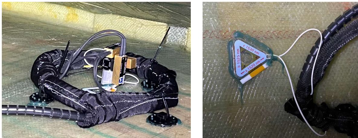
Abbildung 104: Nahaufnahmen eines Montagewürfels mit drei Interferometern (links) sowie einer faseroptischen Dehnungsrosette (rechts), montiert innerhalb des Offshore-Rotorblattes
