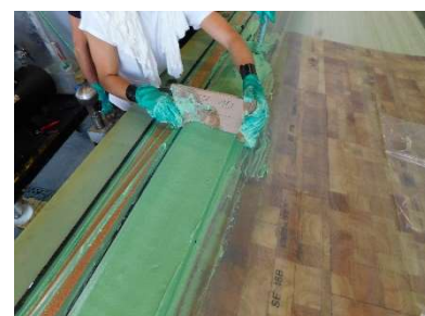
Abbildung 72: Modellierung der Klebstoffraupe auf der Hinterkante
