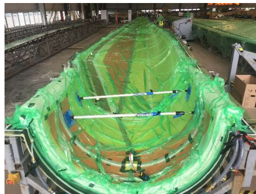
Abbildung 40: Infusionsaufbau Saugseite unter Vakuum
