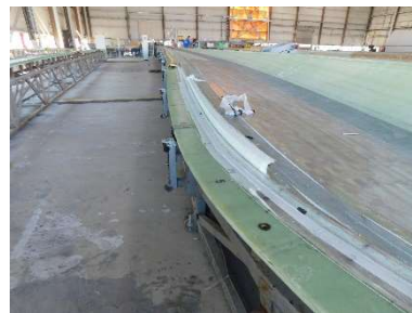
Abbildung 60: Laminierte Klebelippe an der Blattschalen-Hinterkante
