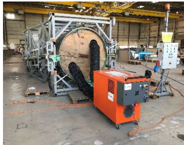
Abbildung 75: Tempern der Rotorblattrohrlings nach dem Klebprozess
