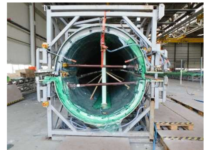
Abbildung 48: Form beim Schließvorgang-
