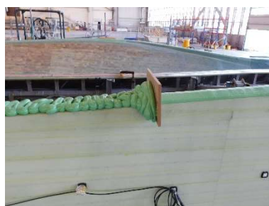
Abbildung 71: Modellierung der Klebstoffraupe auf dem Druckseiten-Stegfuß
