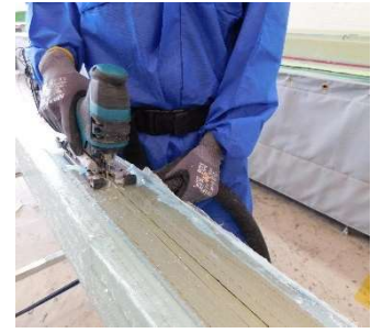
Abbildung 58: Besäumen des Stegs
