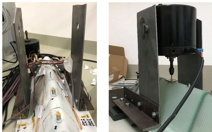
Abbildung 14: Fotografien der Shaker-Befestigung der Subkomponente im dynamischen Versuchsaufbau
