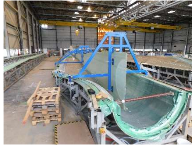
Abbildung 63: Fixieren des Schubstegs in den Positioniervorrichtungen
