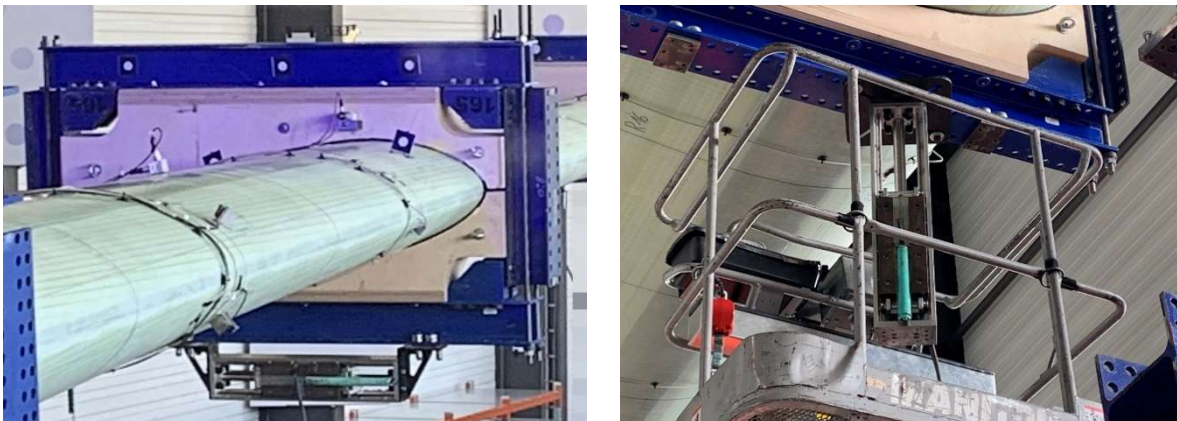
Abbildung 89: Shaker-Anregung unterhalb Lastschere 2 zur Anregung in Schwenkrichtung (links) und in Schlagrichtung (rechts)
