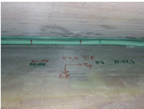
Abbildung 91: Ausschnitt der Klebnahtrisse und Zwischenfaserbrüche in der Blatthinterkante
