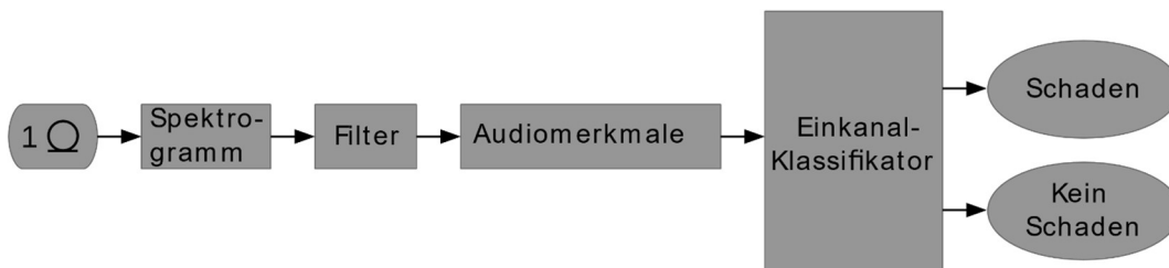
Abbildung 143: Flussdiagramm für den Einkanal-Klassifikator zur Detektion von Schadensereignissen. Der Block „Audiomerkmale“ repräsentiert einen Entscheidungsbaum, der sequenziell alle sechs zuvor beschriebenen Audiomerkmale mit entsprechenden Schwellwerten vergleicht und anschließend ein binäres Klassifikationsergebnis ausgibt. Ein Audiosignal wird nur als „Schaden“ klassifiziert, wenn für alle 6 Audiomerkmale das Schwellwertkriterium eingehalten ist [Kra20].
