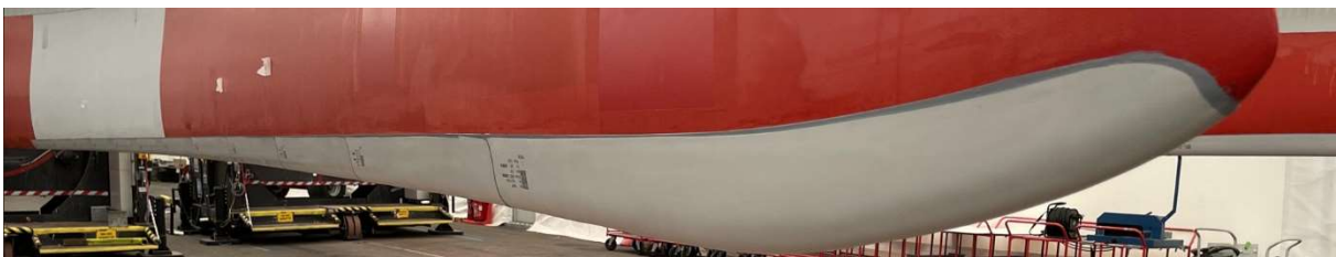
Abbildung 159: Geschützter Vorderkantenbereich durch Polyurethanschalen
