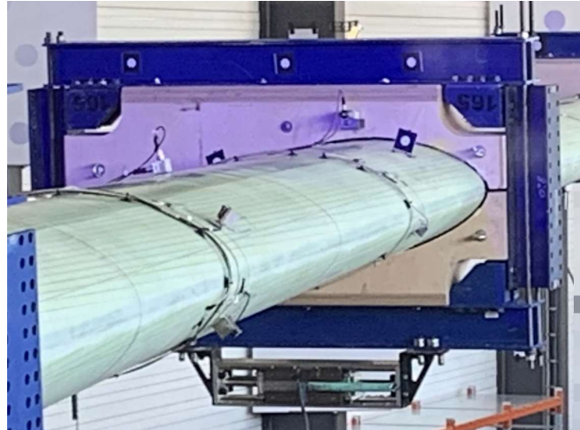
Abbildung 90: Fotografie der Shaker-Ankopplung unterhalb der Lastschere 2 zur Anregung in Schwenkrichtung (edge)
