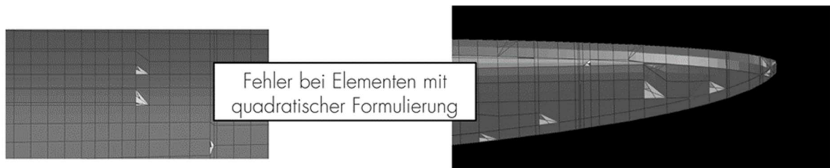
Abbildung 109: Degenerierte 4-Knoten Schalenelemente
