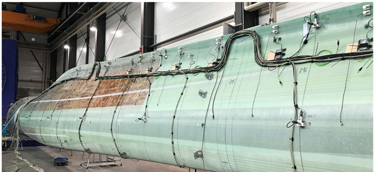
Abbildung 131: Instrumentiertes 30-m Blatt in der Versuchshalle bei FhG IWES
