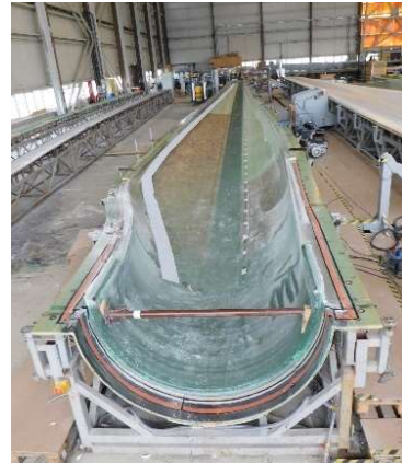
Abbildung 42: Blattschale Saugseite nach Infusion
