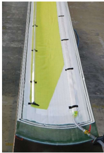
Abbildung 32: Vakuum- infusionsaufbau Gurt-Druckseite
