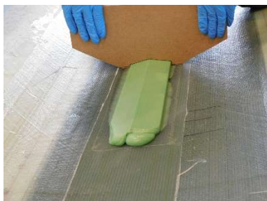
Abbildung 65: Modellieren des Klebers vor der Verklebung
