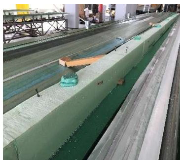
Abbildung 49: Verformung des Klebharzes nach dem Aushärten
