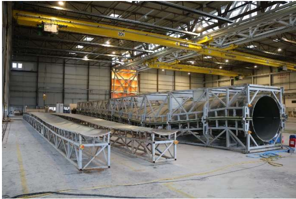
Abbildung 20: Formensatz (Gurtformen, Schalenformen)
