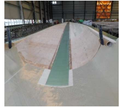
Abbildung 38: Saugseitenform mit Gurt und Sandwichkern.
