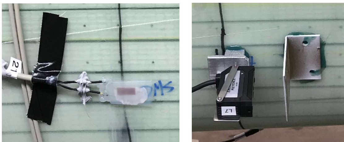
Abbildung 84: Nahaufnahmen eines DMS (links) sowie eines Laser-Distanzsensors (rechts) des ISD am 30 m-Labor-Rotorblatt
