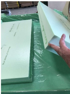
Abbildung 43: Verkleben der Schaumplatten zum Steg-Dummy
