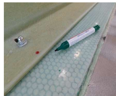
Abbildung 51: Positionsmarken für L-Profil
