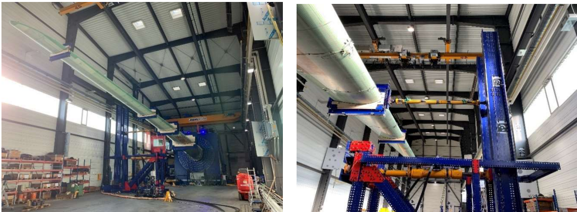
Abbildung 78: Übersicht des Testaufbaus und Detailansicht der Lasteinleitung an Lastschere 2
