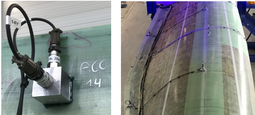
Abbildung 83: Nahaufnahmen der Befestigung eines Beschleunigungssensorpaars des ISD (links) sowie der Druckseite des 30 m-Labor-Rotorblatts (rechts)
