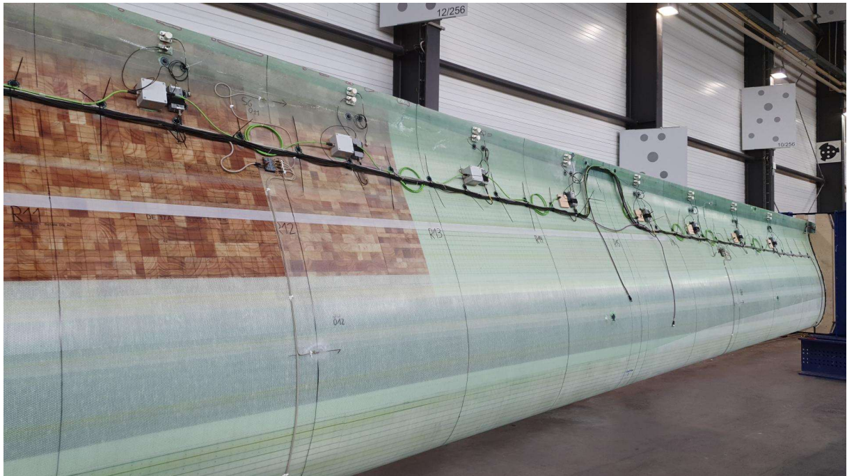
Abbildung 82: Installation des Schallemissionssystems (FHG)
