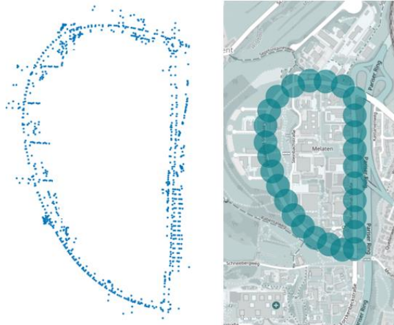
Abbildung 10: Landmarken basierte Karte (links) im Vergleich zum Testfeld Stadt am Campus Melaten (rechts)
