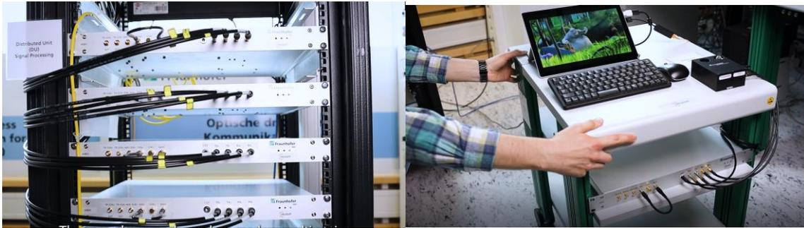
**Abbildung 11** Versuchsaufbau für die FPGA-basierende Echtzeitimplementierung der optischen Drahtlosübertragung mit den Geräten zur DU-Signalverarbeitung (links) und zur Mobile Unit (rechts)
