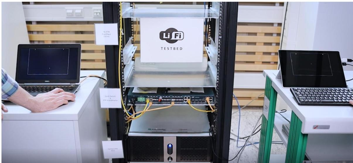
**Abbildung 12** Demonstratoraufbau für die FPGA-basierende Echtzeitimplementierung der optischen Drahtlosübertragung. Die Basisfunktionalität des Systems wurde beispielhaft durch ein einfaches Netzwerkspiel gezeigt.
