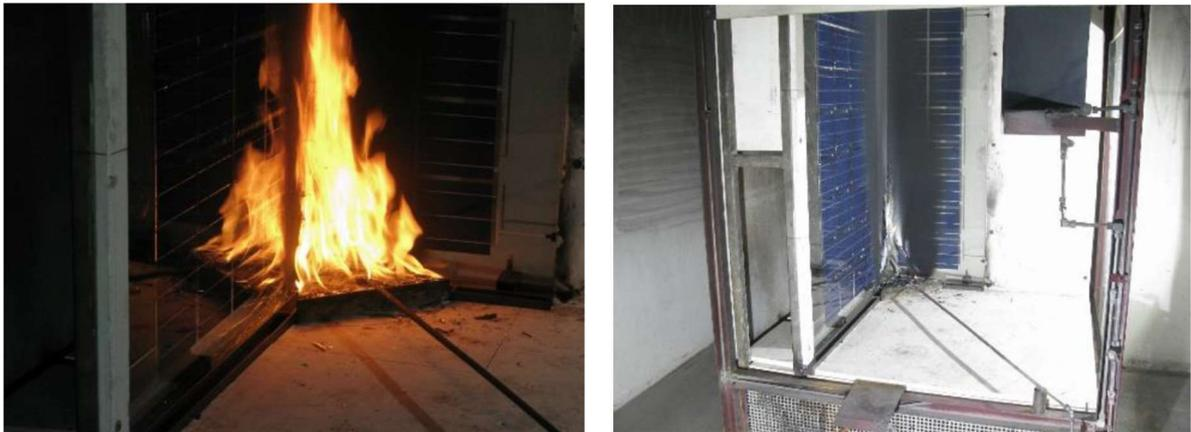
Abbildung 6: SBI Brandversuch nach DIN EN 13823.
