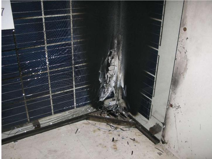
Abbildung 7: Detail SBI Brandversuch nach DIN EN 13823 nach Versuchsende.
