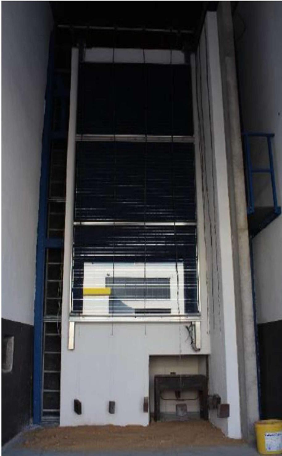
Abbildung 8: Brandversuch nach DIN 4102:20:2017-10.
