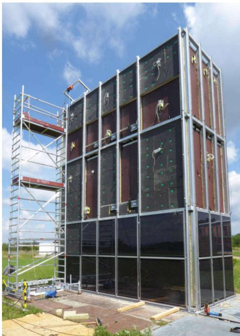
Abbildung 13: Testfassade am Fraunhofer IEE während der Montage
