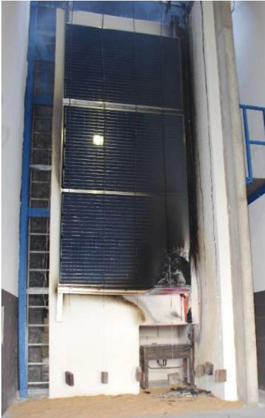
Abbildung 10: Brandversuch nach DIN 4102:20:2017-10.
