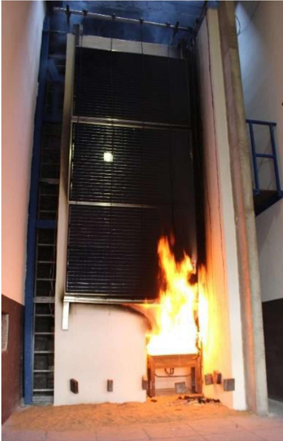
Abbildung 9: Brandversuch nach DIN 4102:20:2017-10.
