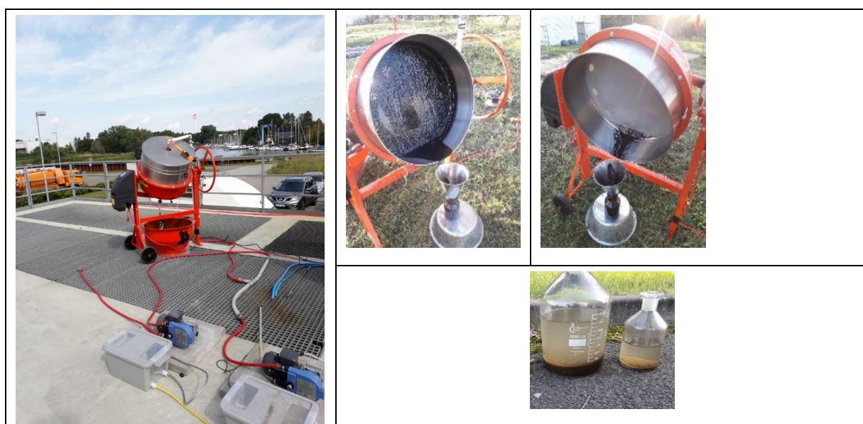
Abbildung 2-11: RoSi (Rotierender Siebfilter): Apparatur zur Aufkonzentrierung der Feldproben
