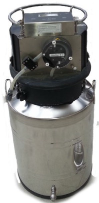
Abbildung 2-5: Automatischer Probenehmer auf einem 100 l fassenden Edelstahlbehälter zur Mikroplastikprobenahme im Zulauf der Kläranlage
