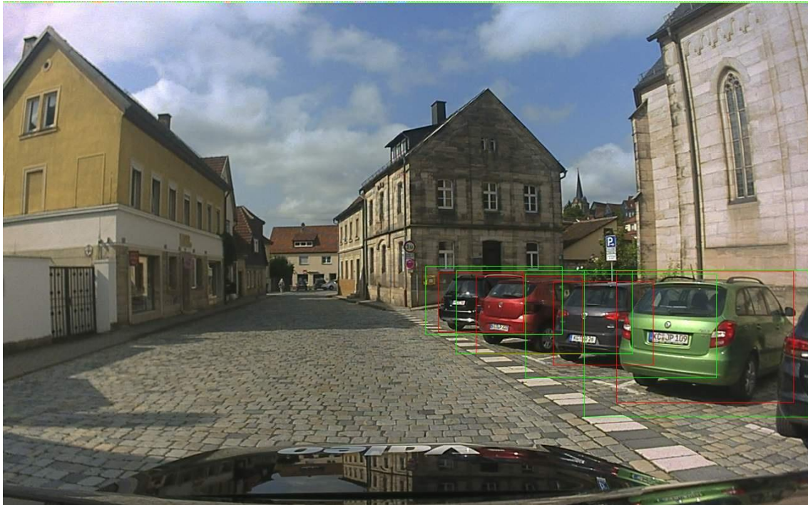
Abbildung 37: Projizierte LIDAR-Erkennung, Kameraerkennung
