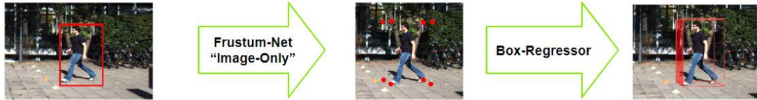
Abbildung 5: 3D Objektinformationen mit Hilfe einer Sub-Version von Frustum-PointNet
