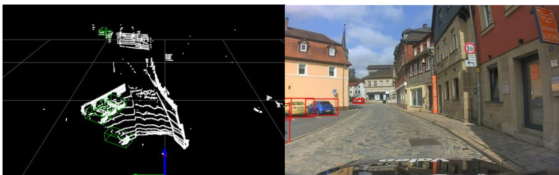
Abbildung 36: Im Bild erkannte Objekte und 3D-Bounding-Boxen
