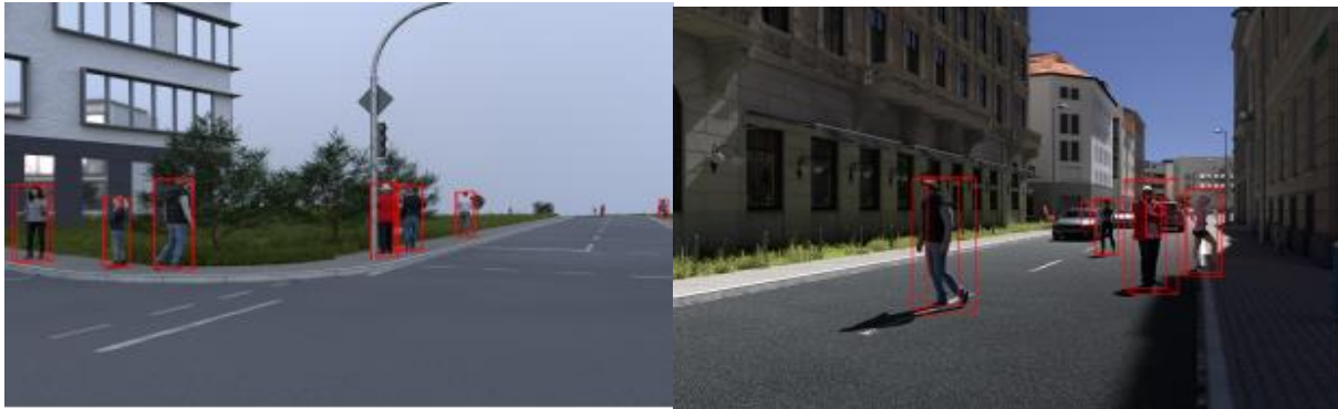
Abbildung 8: Visualisierung der 3D Bounding Box Prädiktion auf dem KIA Datensatz
