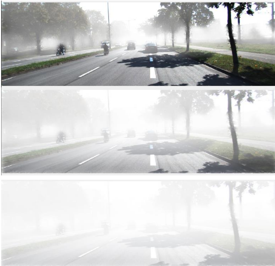
Abbildung 34: Illustration von "salt and pepper" noise sowie der Generierung von Nebel anhand von KITTI Daten
