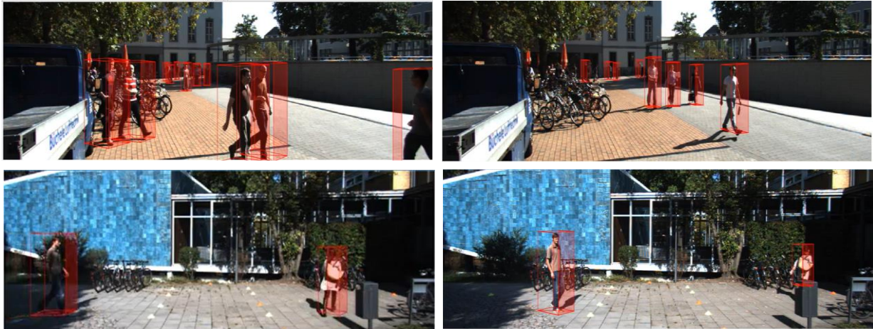
Abbildung 7: Visualisierung der 3D Bounding Boxes Prädiktion auf dem KITTI Datensatz
