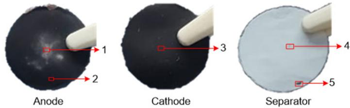
Abbildung 17. Proben im Durchmesser von 10 mm von (a) Graphitanode, (b) LFP-Kathode und (c) Separator.
