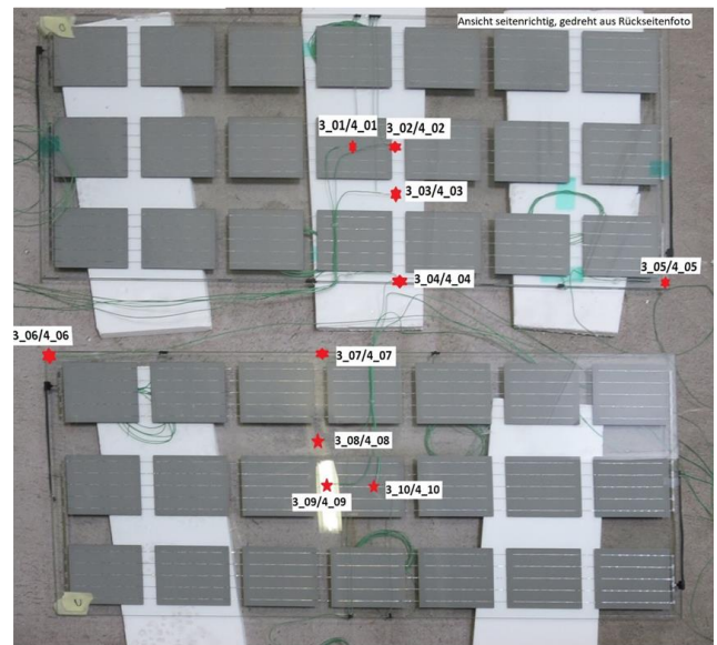
Abbildung 9-4: Modulausführungen und Lage der Messstellen mit vollbelegtem (links) und teilbelegtem (rechts) Zelldesign.
