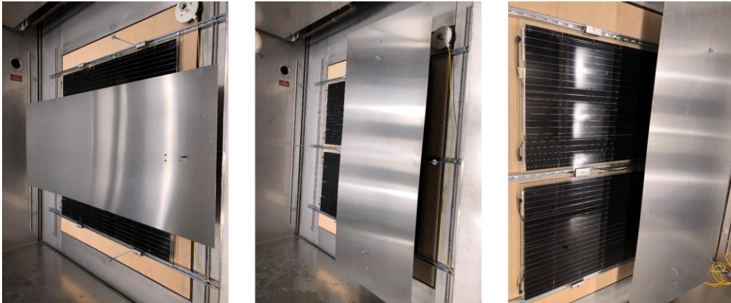
Abbildung 9-6: Module mit vollflächiger Zellbelegung bei horizontaler und vertikaler Teilverschattung.
