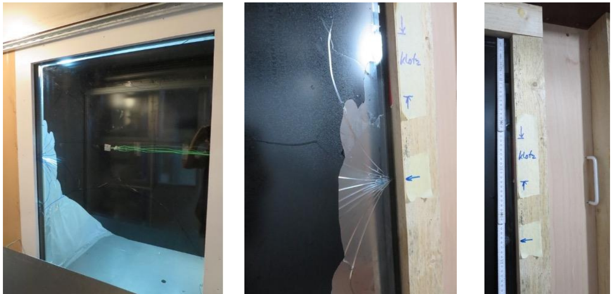
Abbildung 8-14: Wärmedämmglas - Teilverschattung unten, Wärmedämmung oben, mit schwarzer Folie - thermisch induzierter Glaskantenbruch der Innenscheibe.
