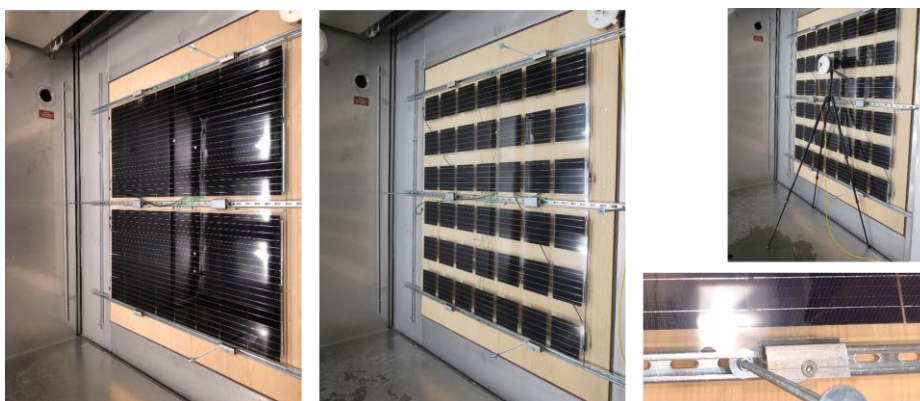
Abbildung 9-5: Jeweils zwei baugleiche Module mit vollflächiger und teiltransparenter Zellbelegung mit punktueller Klemmbefestigung im Versuchsstand.
