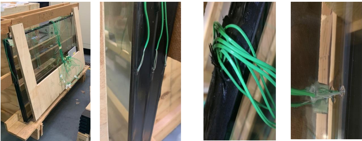
Abbildung 8-3: Isolierglasprobekörper, Links: Isolierglas auf Holzständer, Mitte links: Thermoelemente am Glasrand, Mitte rechts: Thermoelemente-Herausführung aus Scheibenzwischenraum und rechts: Thermoelemente im Scheibenzwischenraum.
