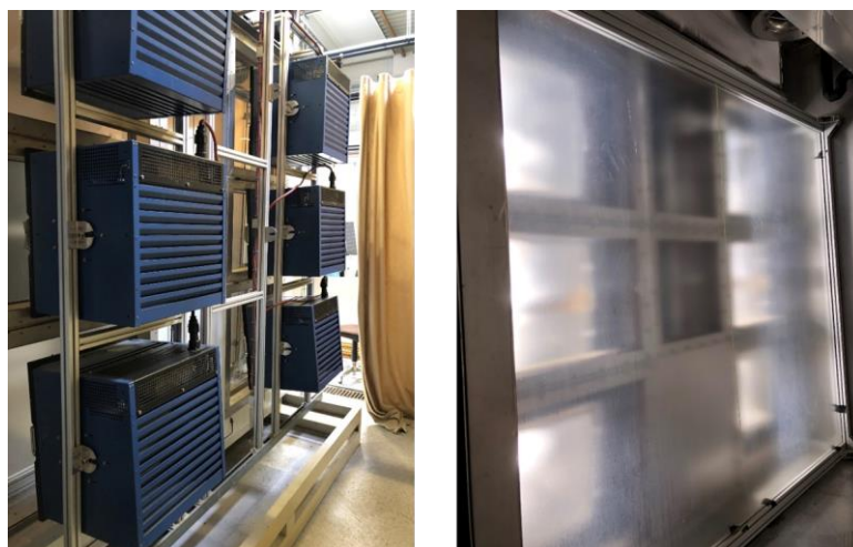
Abbildung 8-2: Anordnung der Strahlungslampen außerhalb der Doppel-Klimawechselkammer (links) und Solarstrahler mit vorgesetzter Diffusorscheibe im Außenmodul, ausgerichtet auf die Versuchskörper (Mitte).
