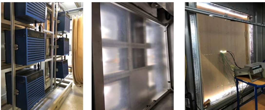
Abbildung 9-2: Anordnung der Strahlungslampen außerhalb der Doppel-Klimawechselkammer (links) und Solarstrahler mit vorgesetzter Diffusorscheibe im Außenmodul, ausgerichtet auf die Versuchskörper (Mitte); Ansicht auf die Rückseite der Holztafelung hinter den PV-Modulen innerhalb der Prüfkammer im Innenmodul (rechts).
