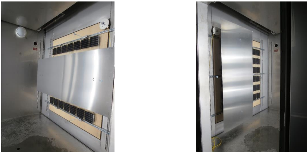
Abbildung 9-7: Module mit teilflächiger Zellbelegung bei horizontaler und vertikaler Teilverschattung.
