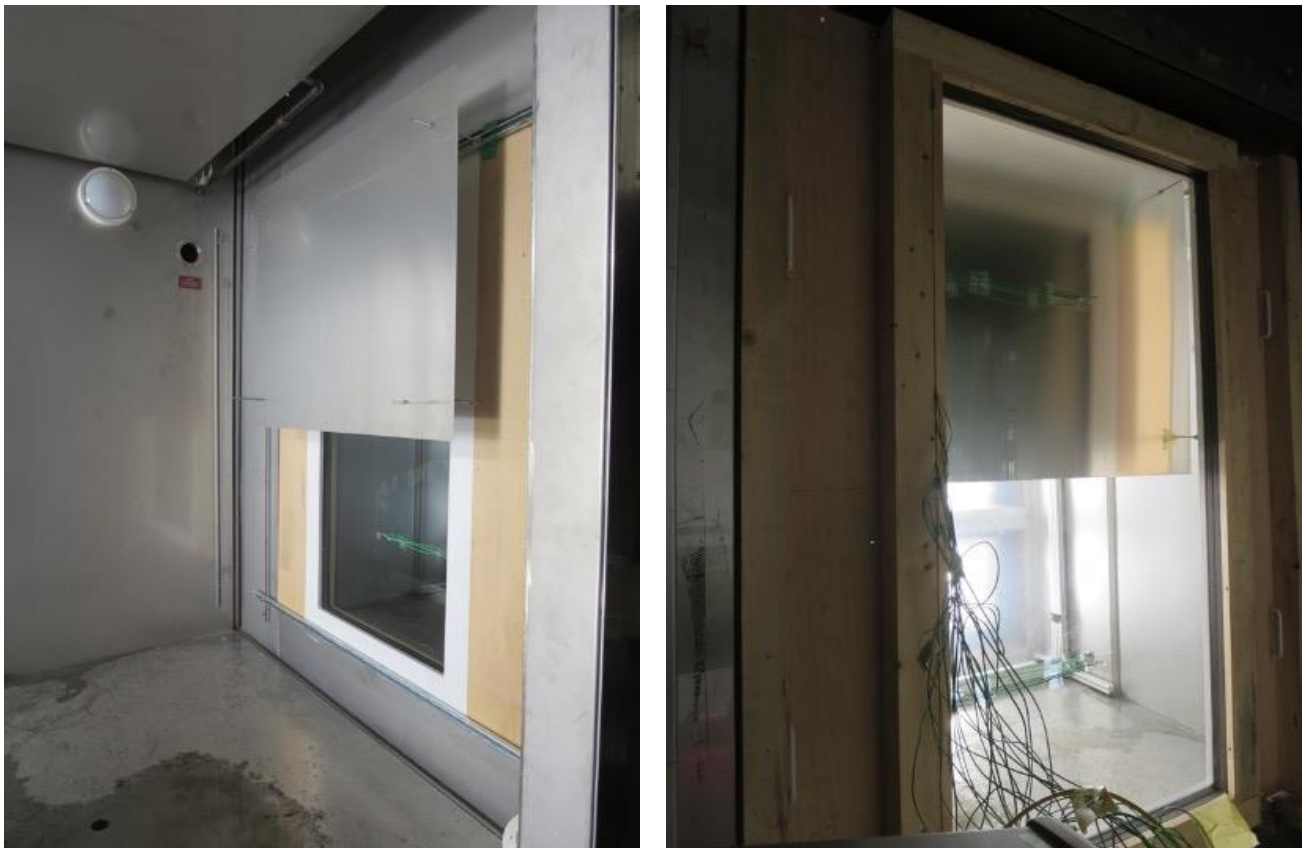
Abbildung 8-6: Eingebautes Dreifach-Isolierverglas, links: Außenmodul (AM) der Klimakammer mit eingebautem Sonnenschutzglas; rechts: Innenmodul (IM) der Klimakammer mit eingebautem Sonnenschutzglas.
