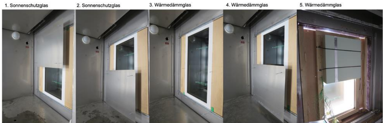
Abbildung 8-7: Übersicht der Validierungsversuche für Isoliergläser.
