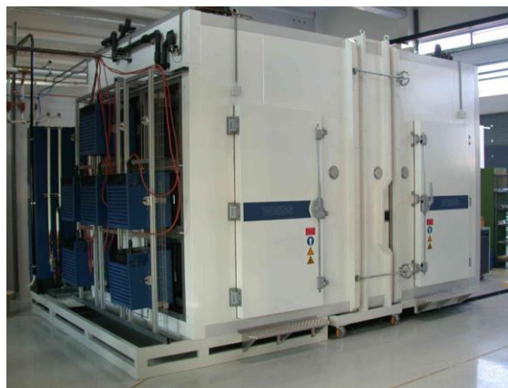
Abbildung 9-1: Sicht auf die Doppel-Klimawechselkammer im TestLab PV Modules am Fraunhofer ISE mit Außenmodul (linke Kammer) und Innenmodul (rechte Kammer).
