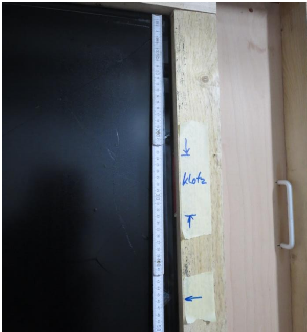
Abbildung A-G: Versuch 5 – Lage des Bruchsprungs der Innenscheibe.
