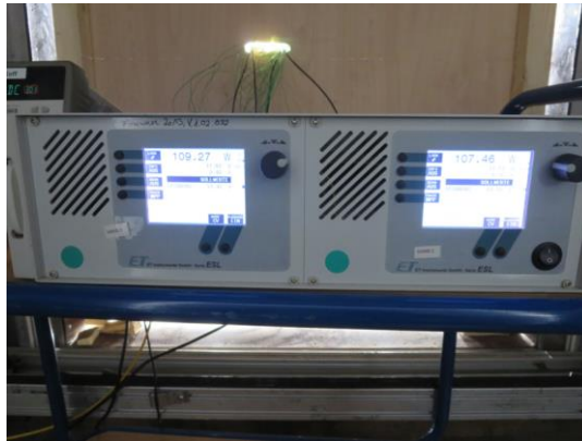
Abbildung 9-3: Elektronische Last mit Typ ESL-Solar.
