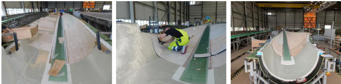
Abbildung 24: Zuordnung und Ablage der Kernwerkstoffe
