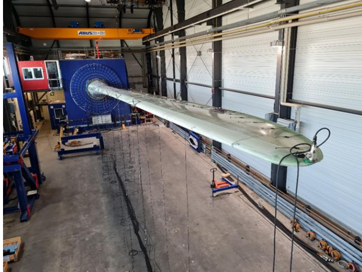
Abbildung 33: Modalanalyse ohne Lastscheren
