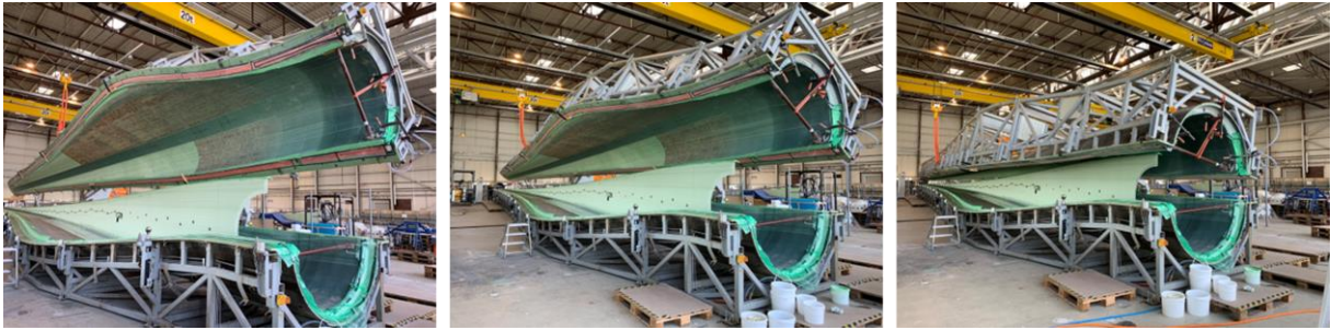
Abbildung 29: Wendevorgang der Druckseitenschale
