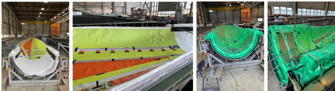
Abbildung 25: Vakuumaufbau und Infusion
