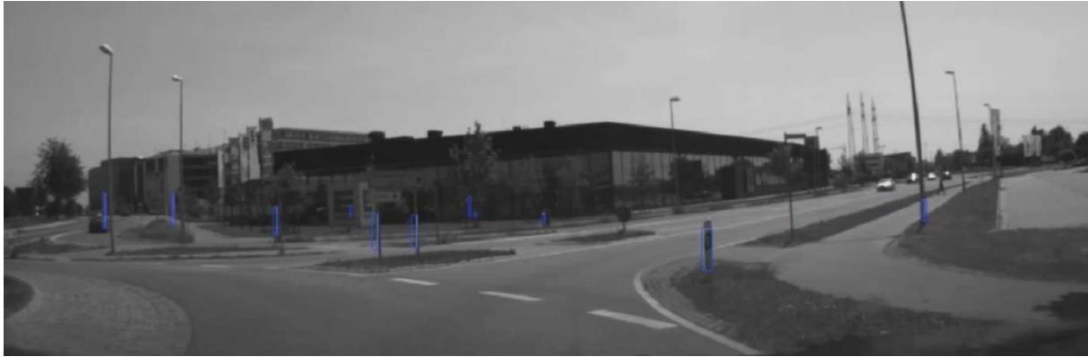
Abbildung 17: Lidarbasierte Landmarkenerkennung insbesondere Pfeile (Straßenlaternen, Leitpfosten Schilderpfosten) zur Nutzung für die Lokalisierung, welche hier ins Videobild zur Kontrolle der Erkennungsleistung rückprojiziert wurden
