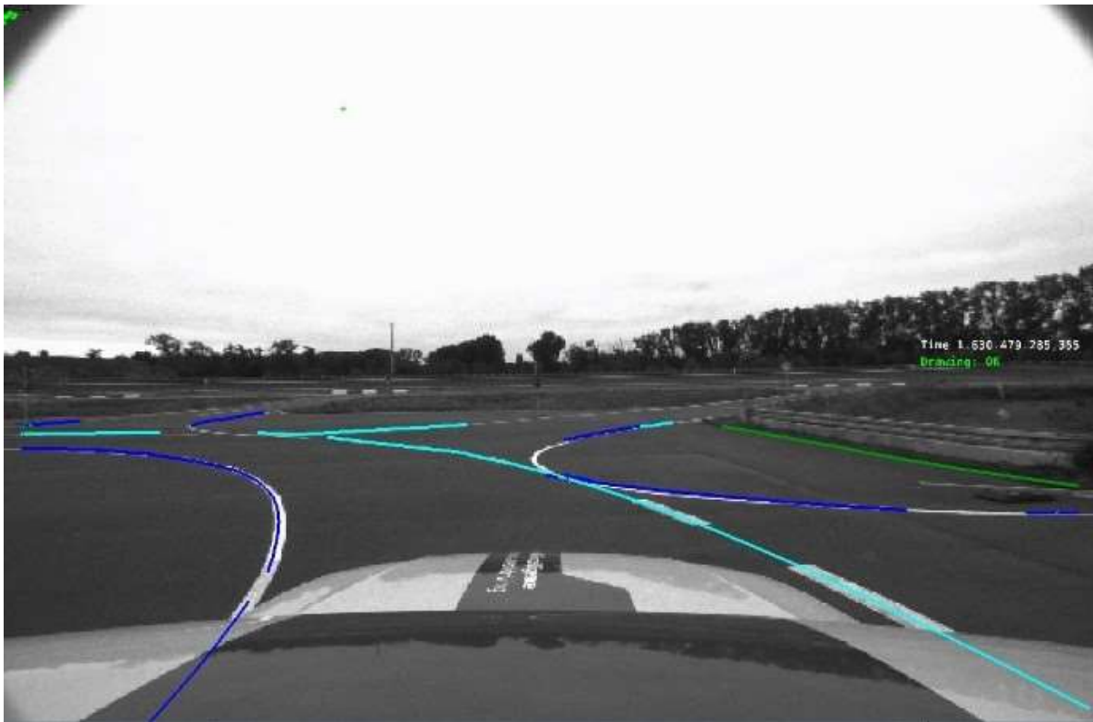
Abbildung 28: Overlay der Fahrstreifengrenzen ins Videobild an einem Kreisverkehr
