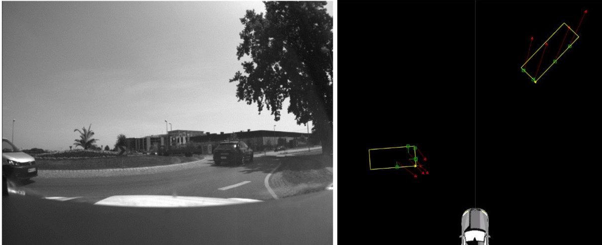
Abbildung 36: links) das Videobild der Szene und rechts) in Gelb die Objekttracks, in Rot: Radar-detections mit Radialgeschwindigkeit und in Grün: den Punkt, zu dem Locations assoziiert werden und das zugehörige Residuum
