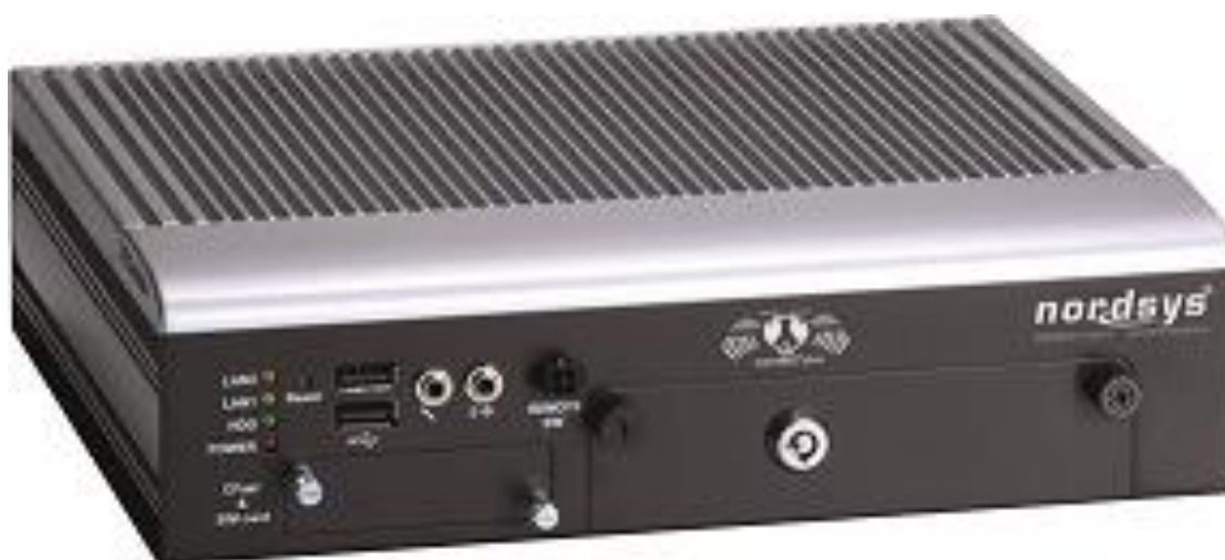
Abbildung 35: In IMAGinE eingesetzte Kommunikationshardware waveBEE
