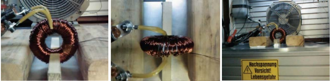
Abbildung 9: Versuchsaufbau für Lärmpegel-Messungen in der Lärmkammer
