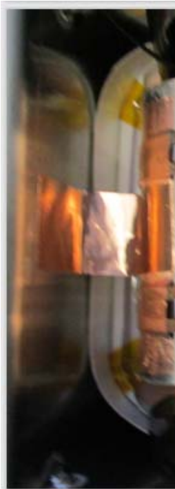
Abbildung 21: Versuchsträger zur Ermittlung der Aussetzspannung
