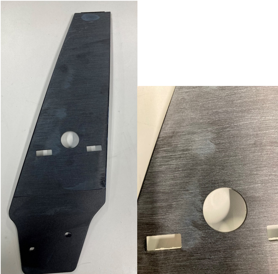
Abbildung 24: Abgeschliffene Arteon-B-Säule mit Bohrungen.
