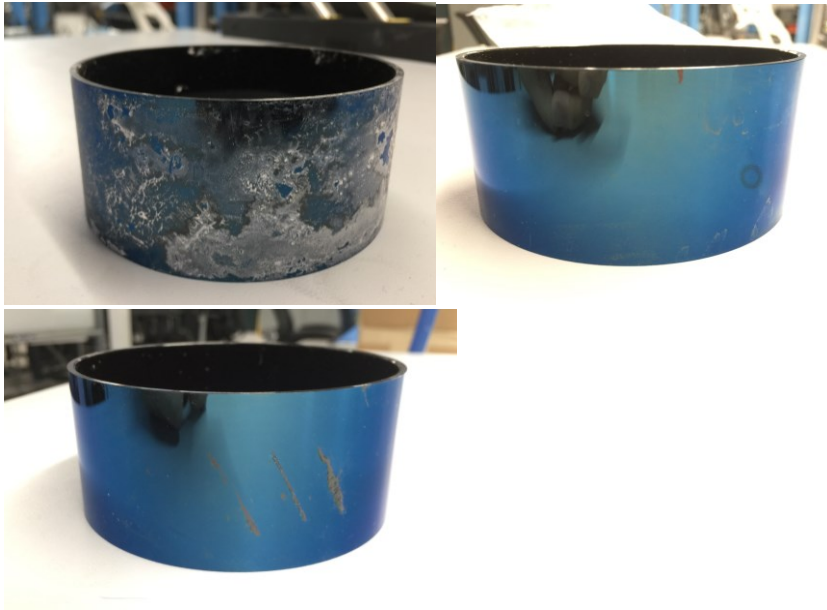
Abbildung 14: Sensorringlinsen mit entspiegeltem Dünnglaslaminat (50 \mu\text{m} Glas) mit verschiedenen Verschmutzungen. Oben links nach Verschmutzung mit Normschmutz (Vogelkotsimulanz, Salz und Sand), oben rechts nach Waschstraßentest, unten links nach Waschstraßentest an mit Baumharz versehener Probe.
