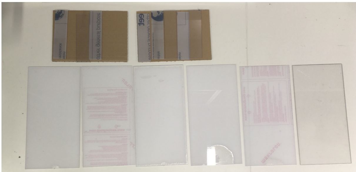
Abbildung 9: Fertiges Laminat bestehend aus zylindrischer Polycarbonat Ringlinse/OCA/Dünnglas hergestellt mit einer Applikationshilfe bei Fa. Tesa. Es wurde 50 µm Dünnglas verwendet (Schott AF32).
