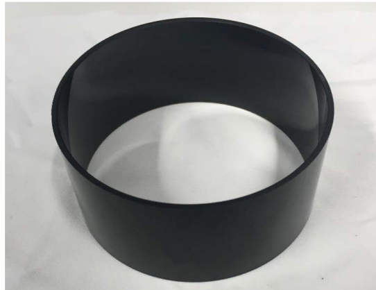
Abbildung 9: Fertiges Laminat bestehend aus zylindrischer Polycarbonat Ringlinse/OCA/Dünnglas hergestellt mit einer Applikationshilfe bei Fa. Tesa. Es wurde 50 µm Dünnglas verwendet (Schott AF32).
