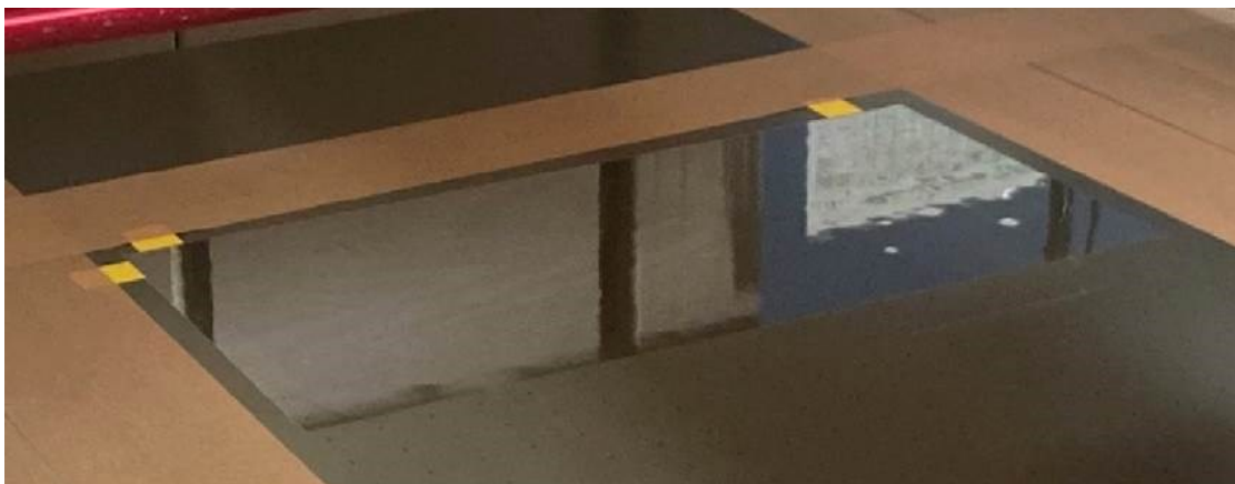
Abbildung 3: Dünnglascheibe auf Drucktisch angesaugt, Unebenheiten der Glasscheibe sind deutlich zu sehen. Die Bedruckungsversuche fanden bei Fa. Flabeg statt.
