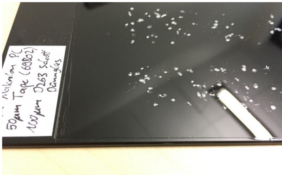
Abbildung 12: 2 mm Polycarbonatplatte mit 100 µm D263 Dünnglas von Schott laminiert mit 50 µm tesa® 69802 Klebeband nach Steinschlagtest.
